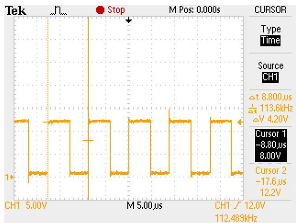
Vin=12Vdc, Po=10W 通道 1: Vds= 5V/格
