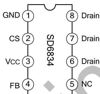
注：建议用户使用时将5脚与Drain端接在一起，可以更好地辅助散热。
