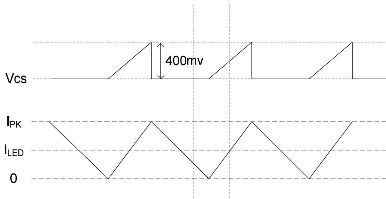
峰值电流计算公式为  $I_{PK}=400/R_{CS}(mA)$ ，其中  $R_{CS}$  为电流采样电阻阻值。LED 输出电流计算公式为  $I_{LED}=I_{PK}/2$
