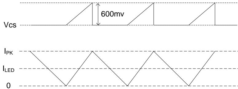
峰值电流计算公式为  $I_{PK}=600/R_{CS}(\text{mA})$ ，其中  $R_{CS}$  为电流采样电阻阻值。LED 输出电流计算公式为  $I_{LED}=I_{PK}/2$
