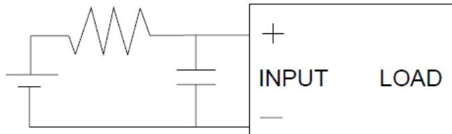
d) 推荐的使用电路，输出端的尖峰电压可能会引起 SSR 误动作，所以请在输出端应加 R/C 回路或压敏电子吸收尖峰电压，具体见下图：
