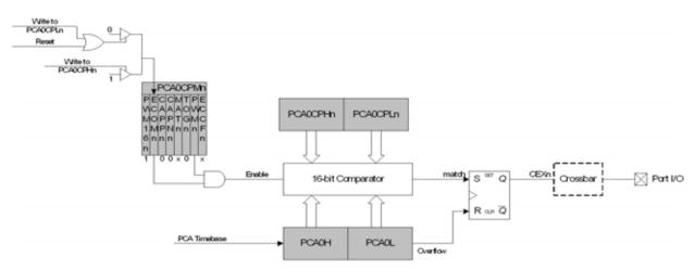
Figure 26.9. PCA 16-Bit PWM Mode
