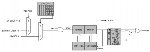
Figure 25.12. Timer 4 16-Bit Mode Block Diagram
