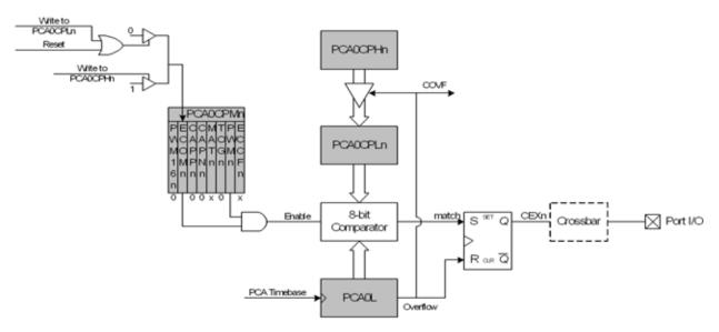
Figure 26.8. PCA 8-Bit PWM Mode Diagram
