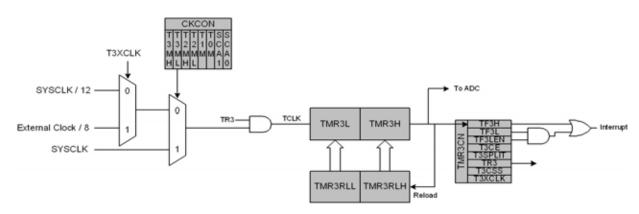
Figure 25.8. Timer 3 16-Bit Mode Block Diagram
