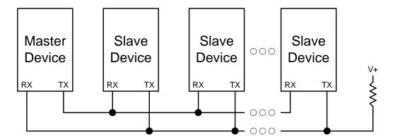
Figure 26.5. UART Multi-Processor Mode Interconnect Diagram
