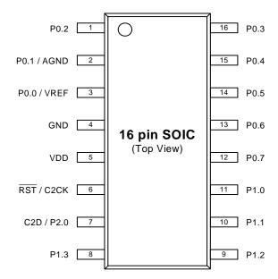
Figure 3.3. C8051F860/1/2/3/4/5-GS and C8051F860/1/2/3/4/5-IS Pinout
