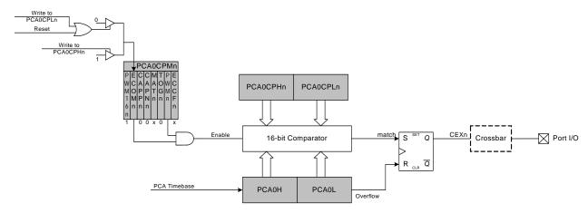
Figure 33.10. PCA 16-Bit PWM Mode
