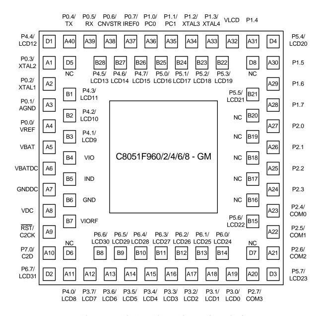
Figure 3.1. DQFN-76 Pinout Diagram (Top View)
