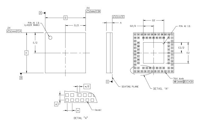
Figure 3.4. DQFN-76 Package Drawing
