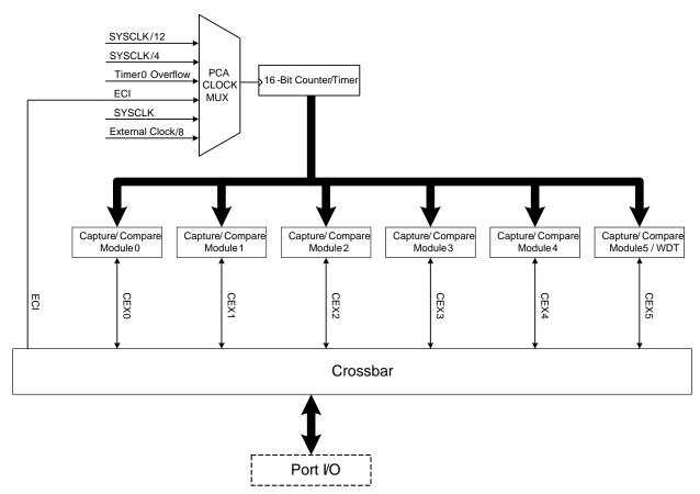
Figure 1.12. PCA Block Diagram
