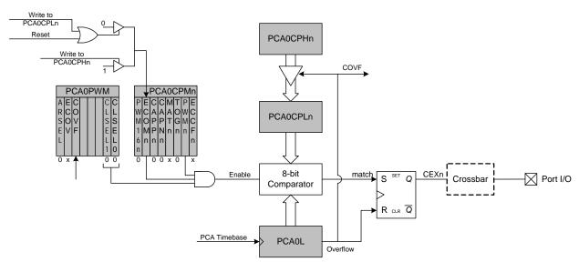
Figure 33.8. PCA 8-Bit PWM Mode Diagram
