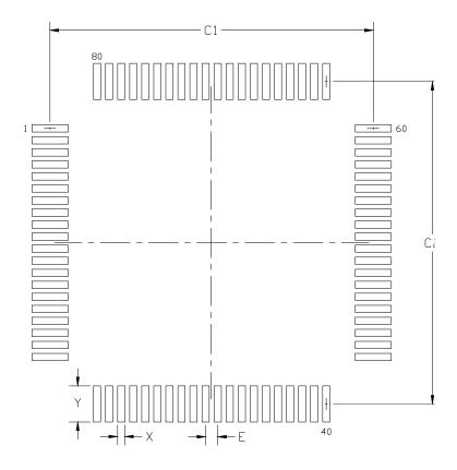
Figure 3.10. TQFP80 Landing Diagram
