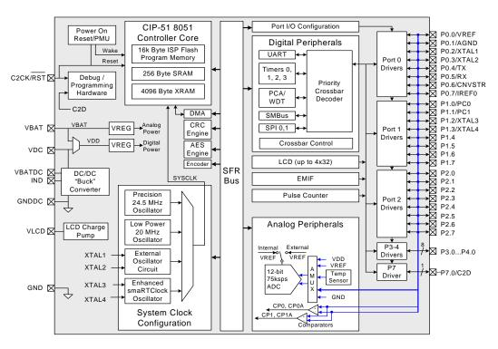
Figure 1.10. C8051F969 Block Diagram
