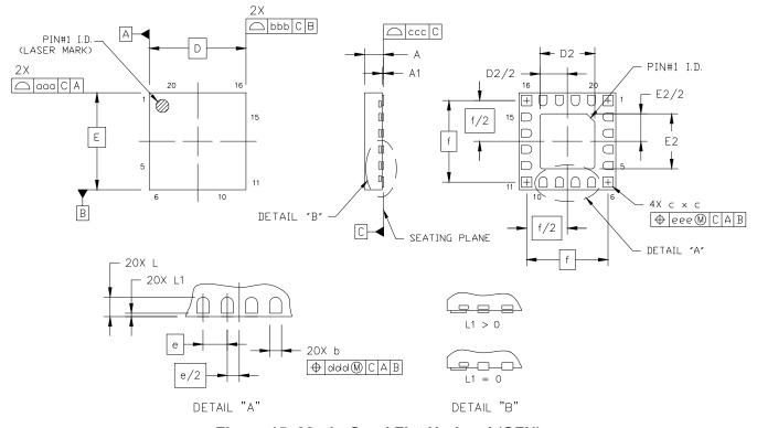
Figure 15. 20-pin Quad Flat No-Lead (QFN)
