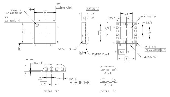
Figure 26. 20-Pin Quad Flat No-Lead (QFN)
