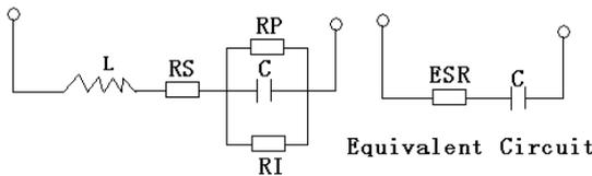
等效串联电阻（ESR）一般由介质材料之极化损耗（RP），绝缘电阻损耗（RI），及由导线导体之接触电阻所产生之损耗（RS）三部份构成。上图左为电容器代表性电路。
