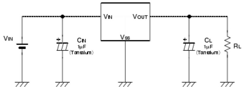
Note1:Input capacitor  $C_{IN}=1\mu F$ .
