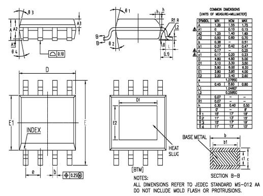
**Dimensions In Millimeters Dimensions In Millimeters** Symbol Symbol Max. Max. Min. Тур. Min. Typ. 1.77 Α D 4.7 4.9 5.1 Α1 0.08 0.18 0.28 Ε 5.8 6 6.2 **A2** 1.2 1.4 1.6 **E**1 3.7 3.9 4.1 1.27BSC **A3** 0.55 0.65 0.75 е b 0.39 0.48 L 0.5 0.65 8.0 0.38 0.43 L1 1.05BSC b1 0.41 С 0.21 0.26 θ 0 8° 2.2 D1 3.1 3.3 3.5 **E2** 2.4 2.6
