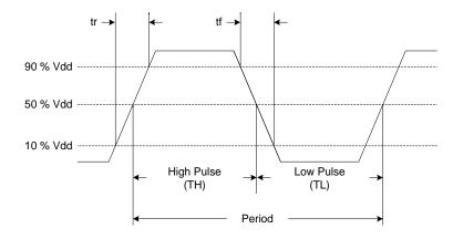
Figure 15. LVCMOS Waveform Diagram<sup>[12]</sup>
