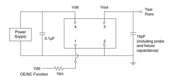
Figure 2. Test Circuit<sup>[8]</sup>
