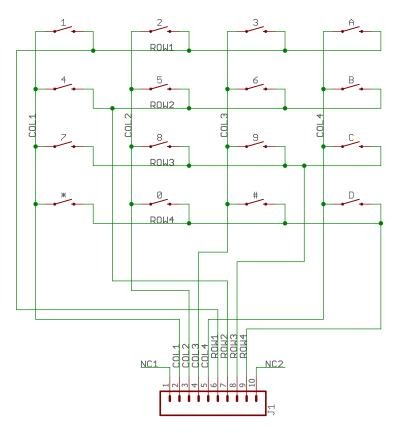
CONNECTOR PINOUT SHOWN FROM TOP (KEYCAP) SIDE OF BOARD
