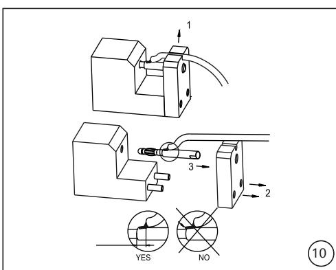
**Um den Stecker aus dem Hilfswerkzeug zu nehmen, zuerst die Leitung aus der Rille ziehen und danach das Hilfswerkzeug auseinanderziehen.**
