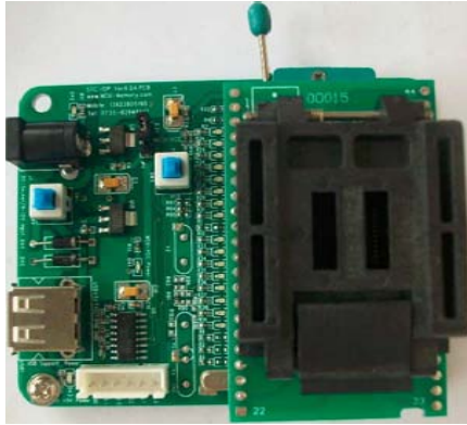
LQFP-48/LQFP-44转换座的安装
