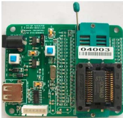
SOP-28转换座的安装
