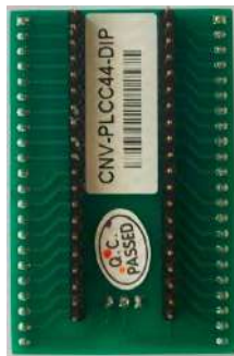
PLCC-44的转换座(反面)
