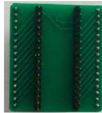
LQFP-32的转换座(反面)
