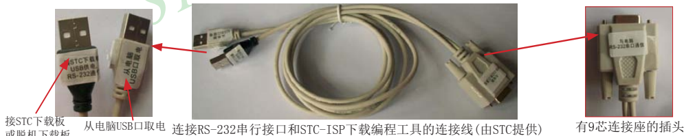
连接RS-232串行接口和STC-ISP下载编程工具的连接线(由STC提供)
