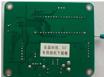
固件版本号为V3.6的脱机下载板(反面)
