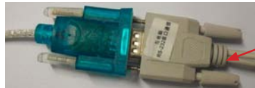
连接线中有9芯连接座的插头插入 USB-RS232转换线的相应插座中
