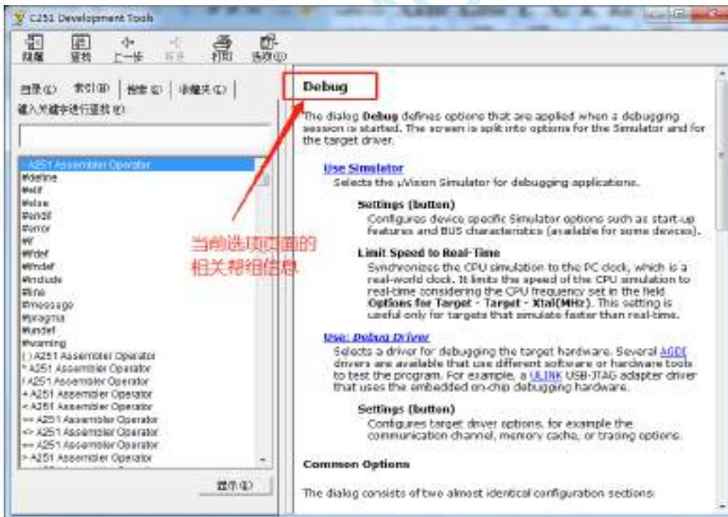
另外，也可在帮助窗口中直接输入想了解的内如。比如需要了解如何在程序中设置特殊的编译指示，可按下图所示，在搜索框输入“#pragma”即可
