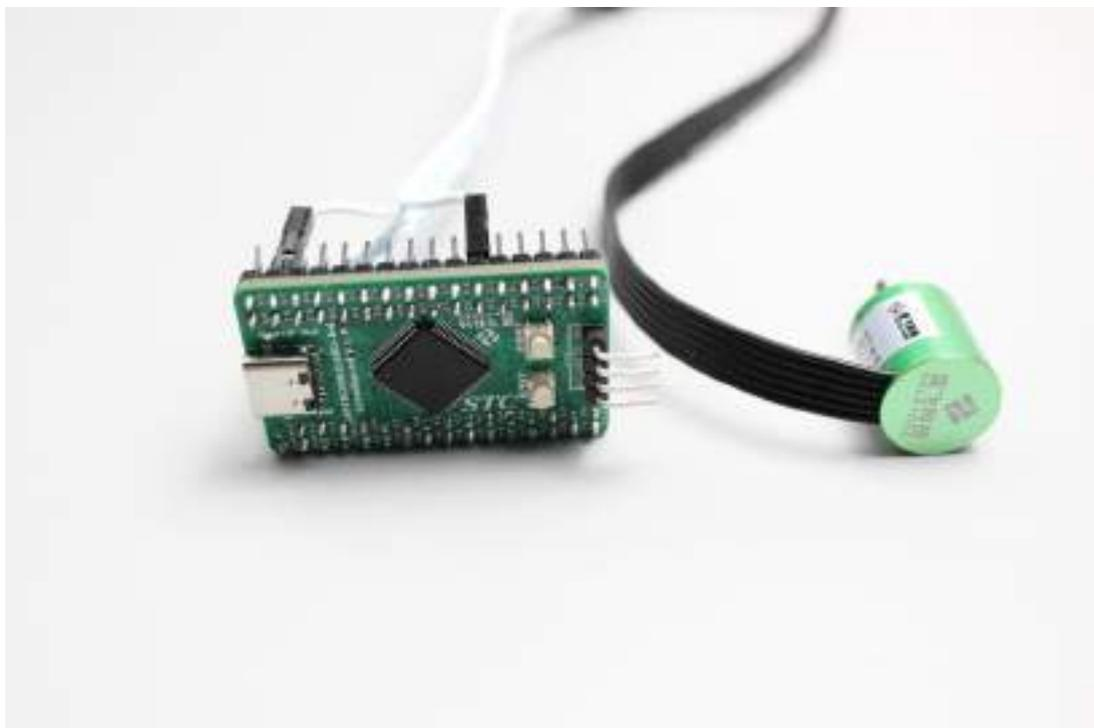
从逐飞科技之前的开源库中我们可以了解到，开源库里没有正交解码例程，主要原因是因为 STC8H 只有两个 PWM 模块，假如我们推荐使用正交编码编码器，就意味着一个编码器就需要占用一个 PWM 模块，然而今年节能组要求制作平衡小车，就意味着有两个电机，这样就需要两个编码器，那么单片机的两个 PWM 模块就会都被占用，然而小车的电机控制也需要 PWM 功能，所以并没有推荐大家用 PWM 模块来实现正交解码，而是推荐大家使用带方向输出的编码器，这样 PWM 模块就可以留给电机使用。
