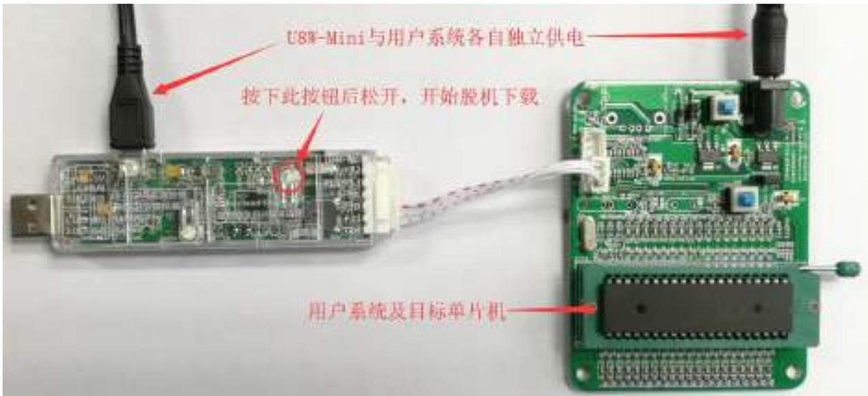
下载的过程中, U8W-Mini 下载工具上的 4 个 LED 会以跑马灯的模式显示。下载完成后, 若下载成功, 则 4 个 LED 会同时亮、同时灭; 若下载失败, 则 4 个 LED 全部不亮。
