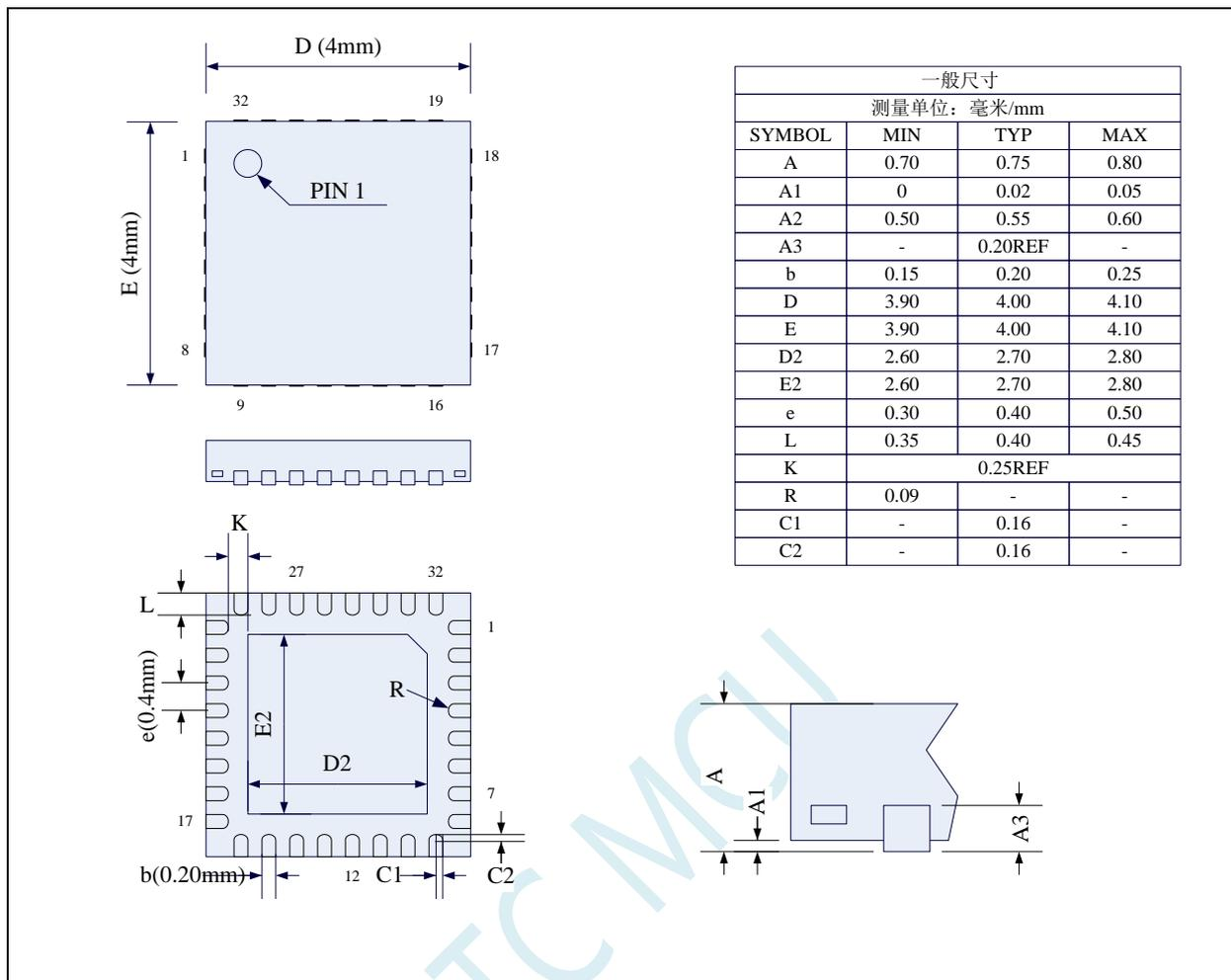
STC 现有 QFN32 封装芯片的背面金属片 (衬底), 在芯片内部并未接地, 在用户的 PCB 板上可以接地, 也可以不接地, 不会对芯片性能造成影响
