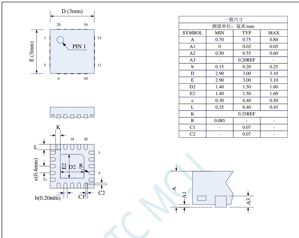
STC 现有 QFN20 封装芯片的背面金属片 (衬底), 在芯片内部并未接地, 在用户的 PCB 板上可以接地, 也可以不接地, 不会对芯片性能造成影响
