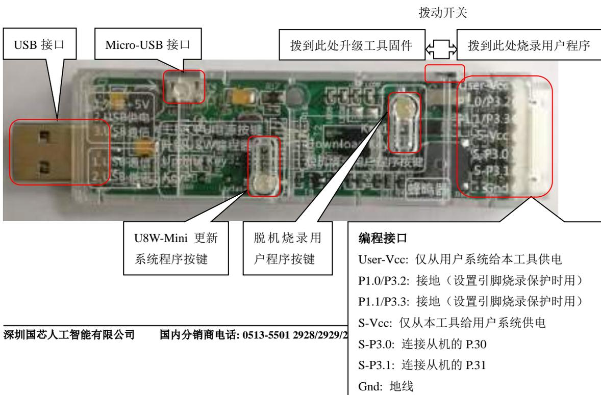
**编程接口:** 根据不同的供电方式, 使用不同的下载连接线连接 U8W-Mini 下载板和用户系统。
