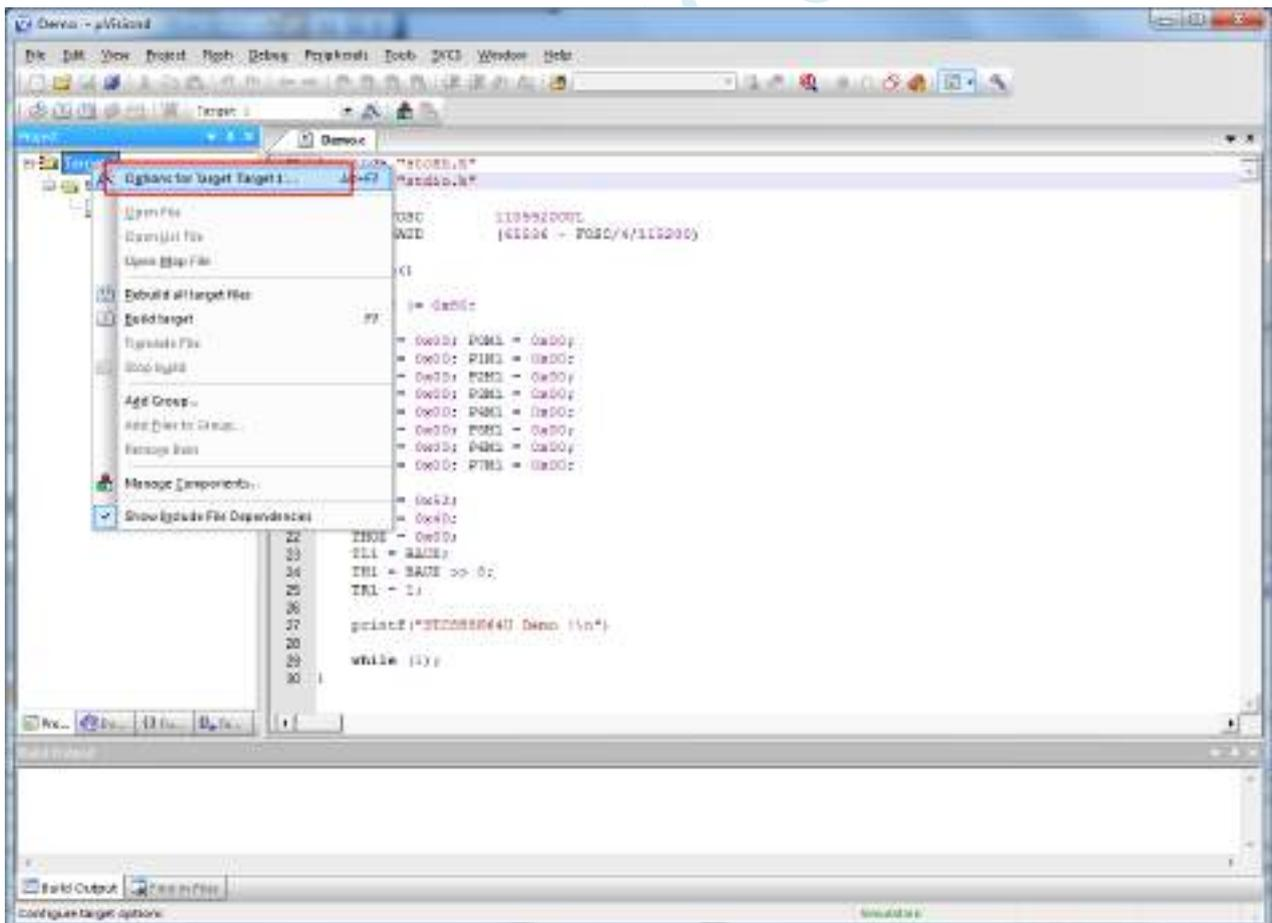
弹出的“Options for Target 'Target 1'”窗口中选择“Target”选项页，在“Memory Model”的下拉选项中可选择“Small”模式或者“Large”模式。
