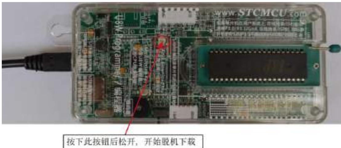
下载的过程中，U8W 下载工具上的 4 个 LED 会以跑马灯的模式显示。下载完成后，若下载成功，则 4 个 LED 会同时亮、同时灭；若下载失败，则 4 个 LED 全部不亮。
