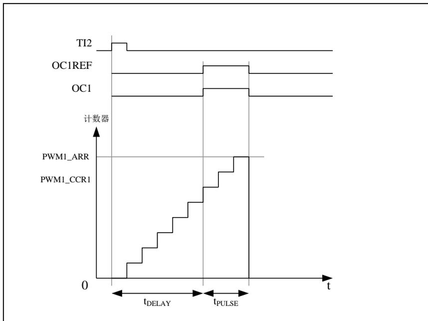
例如, 在从 TI2 输入脚上检测到一个上升沿之后延迟  $t_{\text{DELAY}}$ , 在 OC1 上产生一个  $t_{\text{PULSE}}$  宽度的正脉冲: (假定 IC2 作为触发 1 通道的触发源)
