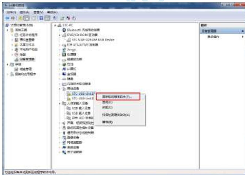
4、在弹出的“更新驱动程序软件”窗口中点击“浏览计算机以查找驱动程序软件”
