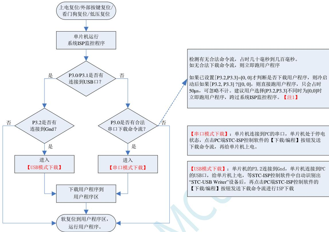
注意：因 [P3.0, P3.1] 作下载/仿真用(下载/仿真接口仅可用 [P3.0, P3.1])，故建议用户将串口 1 放在 P3.6/P3.7 或 P1.6/P1.7，若用户不想切换，坚持使用 P3.0/P3.1 工作或作为串口 1 进行通信，则务必在下载程序时，在软件上勾选“下次冷启动时，P3.2/P3.3 为 0/0 时才可以下载程序”。
