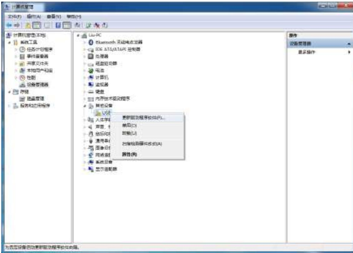
在下面的对话框中选择“浏览计算机以查找驱动程序软件”
