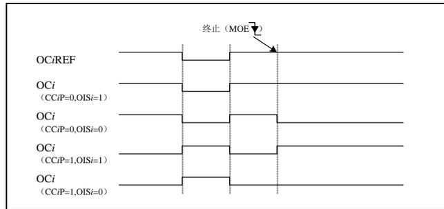
带互补输出的刹车响应的输出 (PWMA 互补输出)
