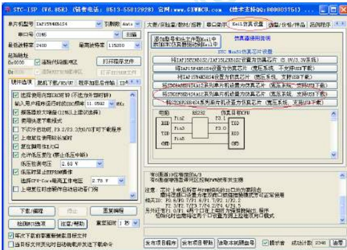
准备一颗 STC8A 系列或者 STC8F 系列的芯片, 并通过下载板连接到电脑的串口, 然后如上图, 选择正确的芯片型号, 然后进入到“Keil 仿真设置”页面, 点击相应型号的按钮, 当程序下载完成后仿真器便制作完成了。
