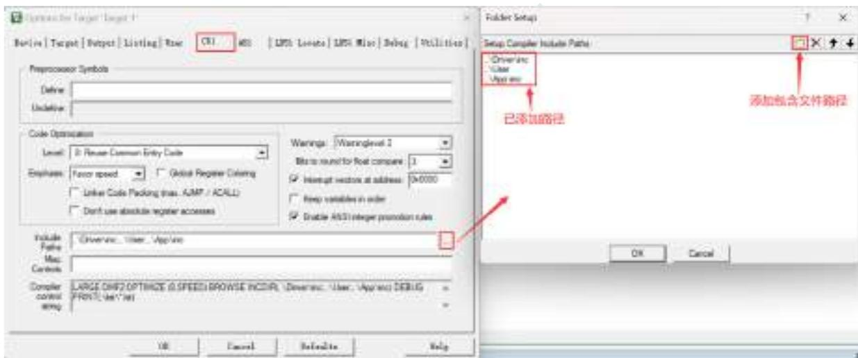
添加后, 调用时直接使用 #include "文件名.h" 就可以将需要的文件包含进来, 编译器会自动到以上路径下面寻找所包含的文件。
