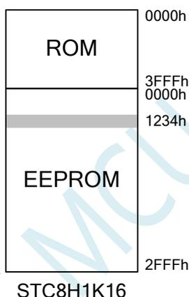
STC12H1K16 的程序空间为 16K 字节（0000h~3FFFh），EEPROM 空间为 12K（0000h~2FFFh）。当需要对 EEPROM 物理地址 1234h 的单元进行读、写、擦除时，若使用 IAP 方式进行访问时，设置的目标地址为 1234h，即 IAP\_ADDRH 设置 12h，IAP\_ADDRL 设置 34h，然后设置相应的触发命令即可对 1234h 单元进行正确操作了。但若是使用 MOVC 方式读取 EEPROM 的 1234h 单元，则必须在 1234h 的基础上还有加上 ROM 空间的大小 4000h，即必须将 DPTR 设置为 5234h，然后才能使用 MOVC 指令进行读取。
