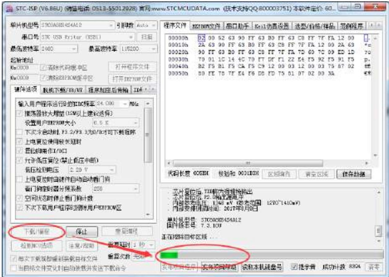
4、直到提示“操作成功”，表示程序代码下载完成。
