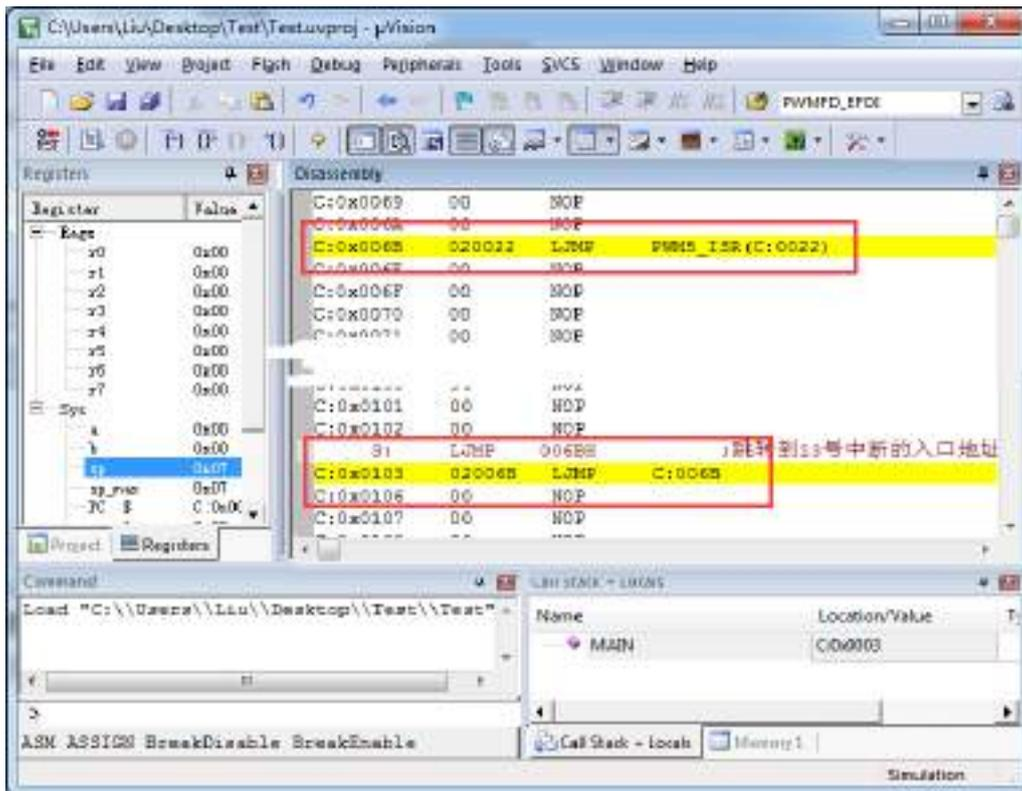
当发生 PWM5 中断时，硬件会自动跳转到 0103H 地址执行“LJMP 006BH”，然后在 006BH 处再执行“LJMP PWM5\_ISR”即可跳转到真正的中断服务程序，如下图：
