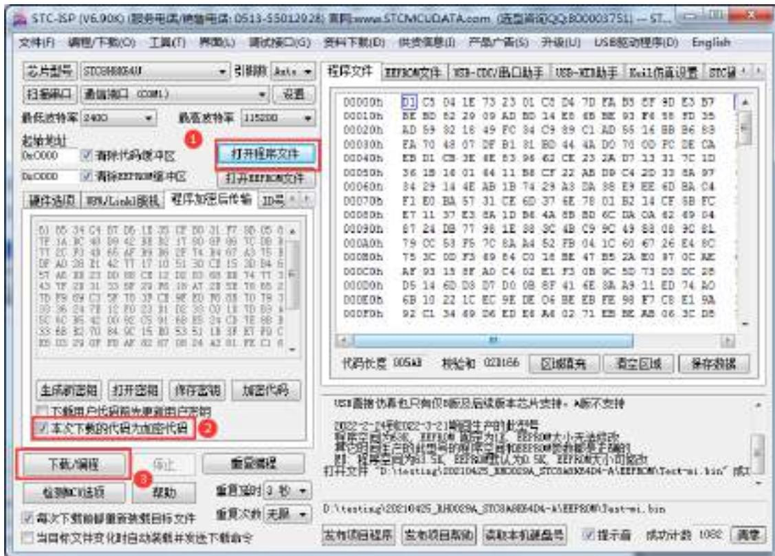
对于一片新的 STC 单片机，可将步骤 3 和步骤 4 合并完成，即将密钥更新到目标单片机的同时也可将加密后的代码一并下载到单片机中，若已经执行过步骤 3（即已经将密钥更新到目标芯片中了），则后续的代码更新就只需要按照步骤 4，只需要在“程序加密后传输”页面中选择“本次下载的代码为加密代码”的选项（“下载用户代码前先更新用户密钥”选项不需要选了），然后打开我们之前加过密后的文件，打开后点击界面左下角的“下载/编程”按钮，按正常方式对目标芯片下载即可完成用户自己专用的加密文件更新用户代码的目的（防止在烧录程序时被烧录人员通过监测串口分析出代码的目的）。
