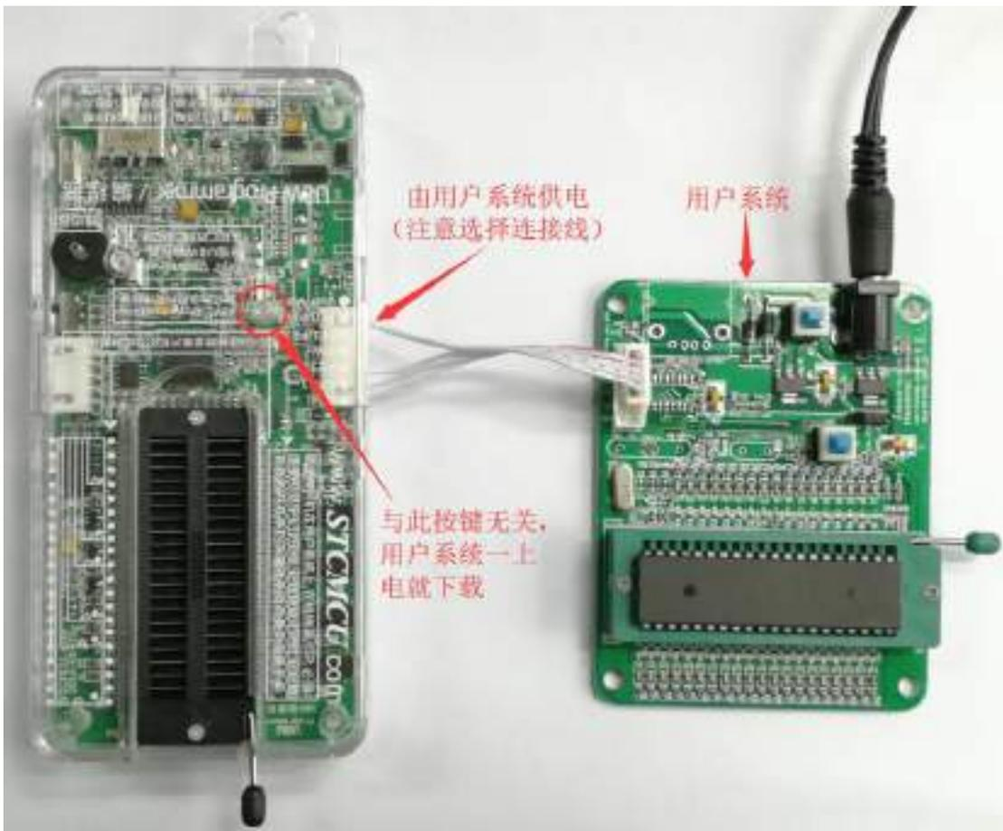
下载的过程中, U8W 下载工具上的 4 个 LED 会以跑马灯的模式显示。下载完成后, 若下载成功, 则 4 个 LED 会同时亮、同时灭; 若下载失败, 则 4 个 LED 全部不亮。
