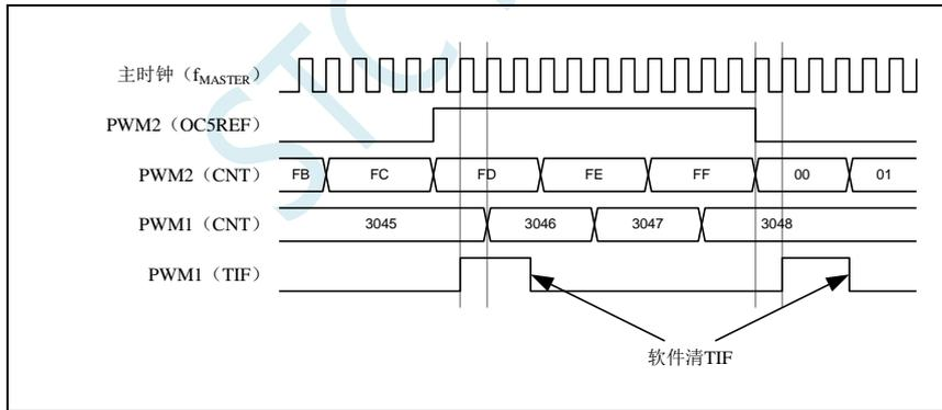
上图中，PWMA 的计数器和预分频器都没有在启动前初始化，所以都是从现有值开始计数的。如果在启动 PWMB 之前复位两个定时器，用户就可以写入期望的数值到 PWMA 的计数器，使之从指定值开始计数。对 PWMA 的复位操作可以通过软件写 PWMA\_EGR 寄存器的 UG 位实现。
