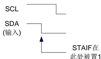
RXIF: 从机模式时接收到 1 字节的数据后的中断请求位。从机模式的 I<sup>2</sup>C 控制器接收到 1 字节的数据后, 在第 8 个时钟的下降沿时硬件会自动将此位置 1, 并向 CPU 发请求中断, 响应中断后 RXIF 位必须用软件清零。RXIF 被置 1 的时间点如下图所示:
