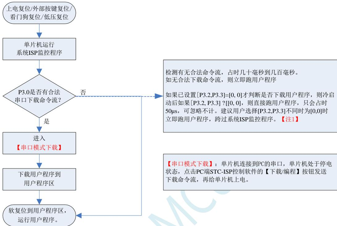
注意：因 [P3.0, P3.1] 作下载/仿真用(下载/仿真接口仅可用 [P3.0, P3.1])，故建议用户将串口 1 放在 P3.6/P3.7 或 P1.6/P1.7，若用户不想切换，坚持使用 P3.0/P3.1 工作或作为串口 1 进行通信，则务必在下载程序时，在软件上勾选“下次冷启动时，P3.2/P3.3 为 0/0 时才可以下载程序”。
