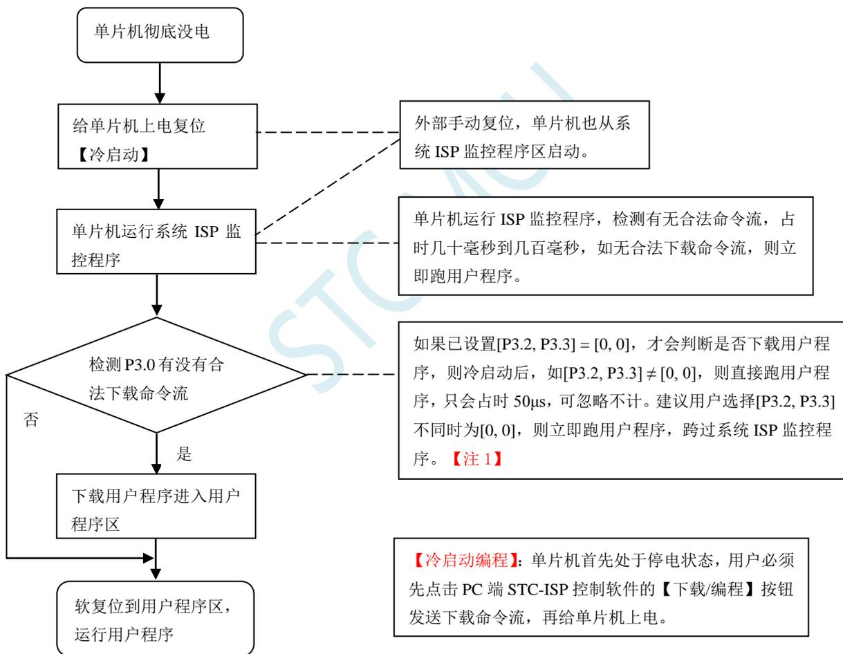
注意：因 [P3.0, P3.1] 作下载/仿真用(下载/仿真接口仅可用 [P3.0, P3.1])，故建议用户将串口 1 放在 P3.6/P3.7 或 P1.6/P1.7，若用户不想切换，坚持使用 P3.0/P3.1 工作或作为串口 1 进行通信，则务必在下载程序时，在软件上勾选“下次冷启动时，P3.2/P3.3 为 0/0 时才可以下载程序”。【注 1】
