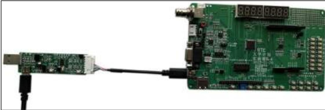
4、一箭双雕用 SIP7-USB-TypeA 对 STC8 系列 MCU 进行仿真/烧录，硬件连接图如下：
