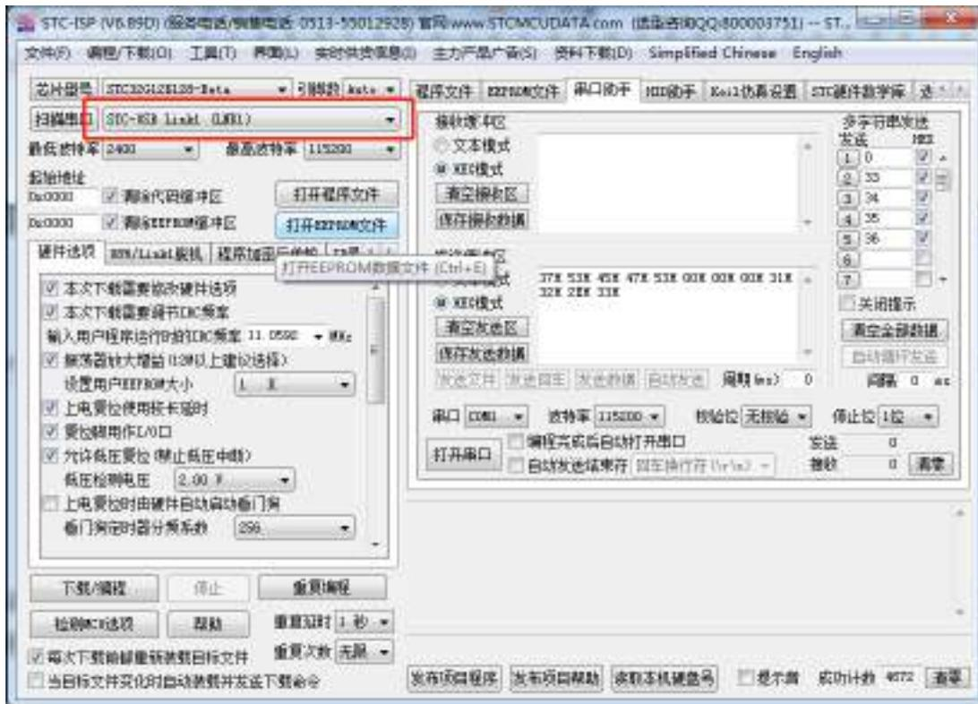
正确识别后, 即可使用 STC-USB Link1D 进行在线 ISP 下载或者脱机 ISP 下载。
