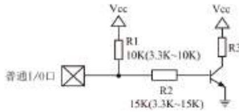
如果上拉控制, 建议加上拉电阻 R1(3.3K~10K), 如果不加上拉电阻 R1(3.3K~10K), 建议 R2 的值在 15K 以上, 或用强推挽输出。
