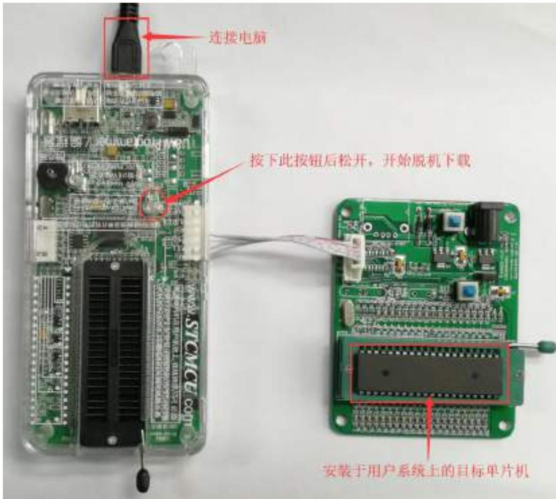
下载的过程中, U8W 下载工具上的 4 个 LED 会以跑马灯的模式显示。下载完成后, 若下载成功, 则 4 个 LED 会同时亮、同时灭; 若下载失败, 则 4 个 LED 全部不亮。
