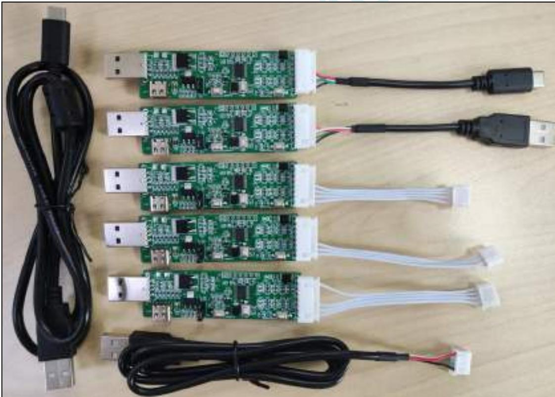
3、一箭双雕用 SIP7-USB-TypeC 对 STC8 系列 MCU 进行仿真/烧录，硬件连接图如下：
