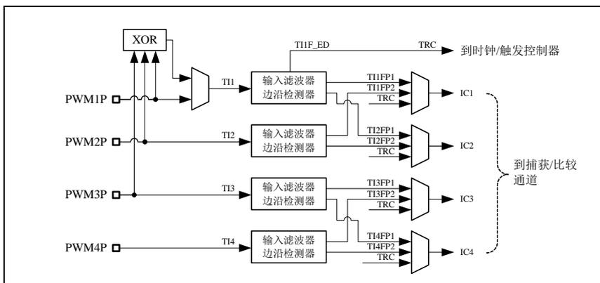
如图，输入部分对相应的 TIx 输入信号采样，并产生一个滤波后的信号 TIxF。然后，一个带极性选择的边缘监测器产生一个信号 (TIxFPx)，它可以作为触发模式控制器的输入触发或者作为捕获控制。该信号通过预分频后进入捕获寄存器 (ICxPS)。
