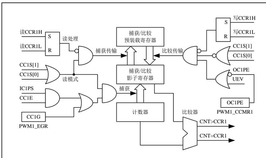
捕获/比较模块由一个预装载寄存器和一个影子寄存器组成。读写过程仅操作预装载寄存器。在捕获模式下，捕获发生在影子寄存器上，然后再复制到预装载寄存器中。在比较模式下，预装载寄存器的内容被复制到影子寄存器中，然后影子寄存器的内容和计数器进行比较。
