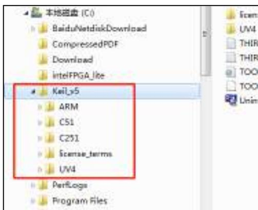
无论是新版本还是旧版本, C51、C251 和 MDK 是安装在不同的目录, 并不会冲突。软件的和谐也是 3 个软件分别进行的, 之前已经安装完成并设置好的软件, 并不会因为后续有安装新的软件而改变。所以安装时只需要按照默认方式安装即可, Keil 软件会自动处理好。
