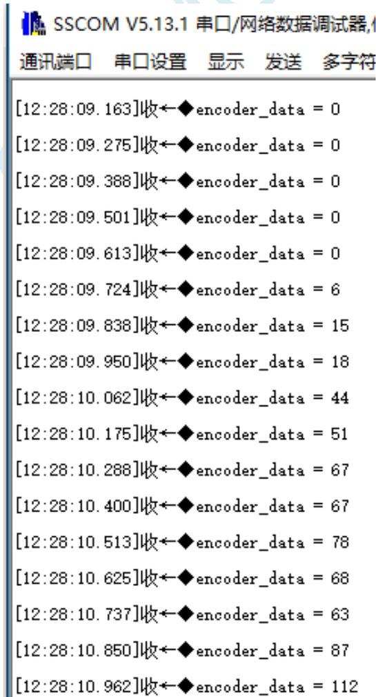
下图是正交编码的编码器逆时针旋转且角速度逐渐增大时的数据:
