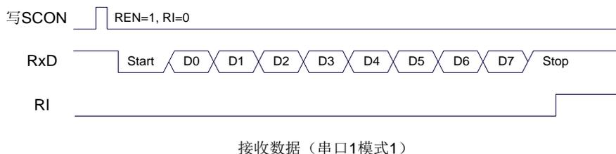
串口 1 的波特率是可变的, 其波特率可由定时器 1 或者定时器 2 产生。当定时器采用 1T 模式时 (12 倍速), 相应的波特率的速度也会相应提高 12 倍。
