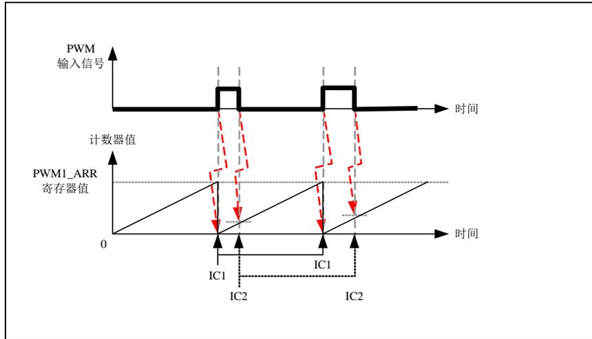
例如，你可以用以下方式测量 TI1 上输入的 PWM 信号的周期 (PWMA\_CCR1 寄存器) 和占空比 (PWMA\_CCR2 寄存器)。
