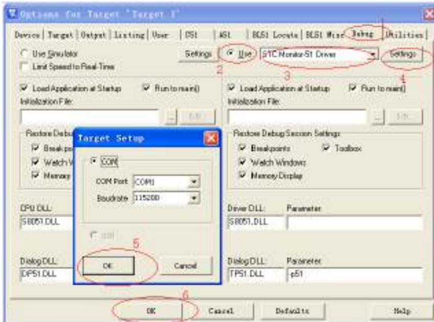
如上图, 首先进入到项目的设置页面, 选择“Debug”设置页, 第 2 步选择右侧的硬件仿真“Use ...”, 第 3 步, 在仿真驱动下拉列表中选择“STC Monitor-51 Driver”项, 然后点击“Settings”按钮, 进入下面的设置画面, 对串口的端口号和波特率进行设置, 波特率一般选择 115200。到此设置便完成了。
