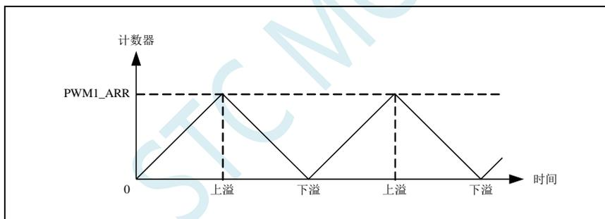
如果定时器带有重复计数器，在重复了指定次数（`PWMA_RCR` 的值）的向上和向下溢出之后会产生更新事件（`UEV`）。否则每一次的向上向下溢出都会产生更新事件。通过软件方式或者通过使用触发控制器置位 `PWMA_EGR` 寄存器的 `UG` 位同样也可以产生一个更新事件。此时，计数器重新从 0 开始计数，预分频器也重新从 0 开始计数。设置 `PWMA_CR1` 寄存器中的 `UDIS` 位可以禁止 `UEV` 事件。这样可以避免在更新预装载寄存器时更新影子寄存器。因此 `UDIS` 位被清为 0 之前不会产生更新事件。然而，计数器仍会根据当前自动重载的值，继续向上或向下计数。如果定时器带有重复计数器，由于重复寄存器没有双重的缓冲，新的重复数值将立刻生效，因此在修改时需要小心。此外，如果设置了 `PWMA_CR1` 寄存器中的 `URS` 位（选择更新请求），设置 `UG` 位将产生一个更新事件 `UEV` 但不设置 `UIF` 标志（因此不产生中断），这是为了避免在发生捕获事件并清除计数器时，同时产生更新和捕获中断。
