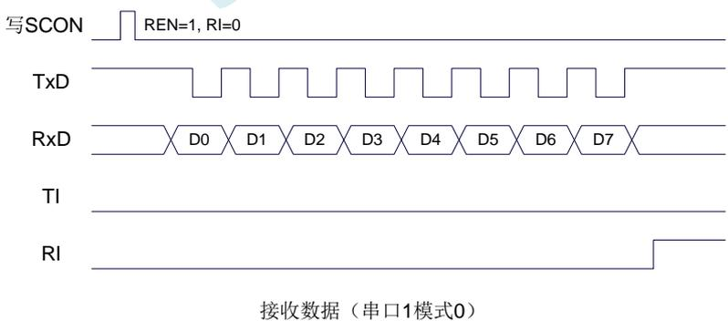
工作于模式 0 时, 必须清 0 多机通信控制位 SM2, 使之不影响 TB8 位和 RB8 位。由于波特率固定为 SYSclk/12 或 SYSclk/2, 无需定时器提供, 直接由单片机的时钟作为同步移位脉冲。
