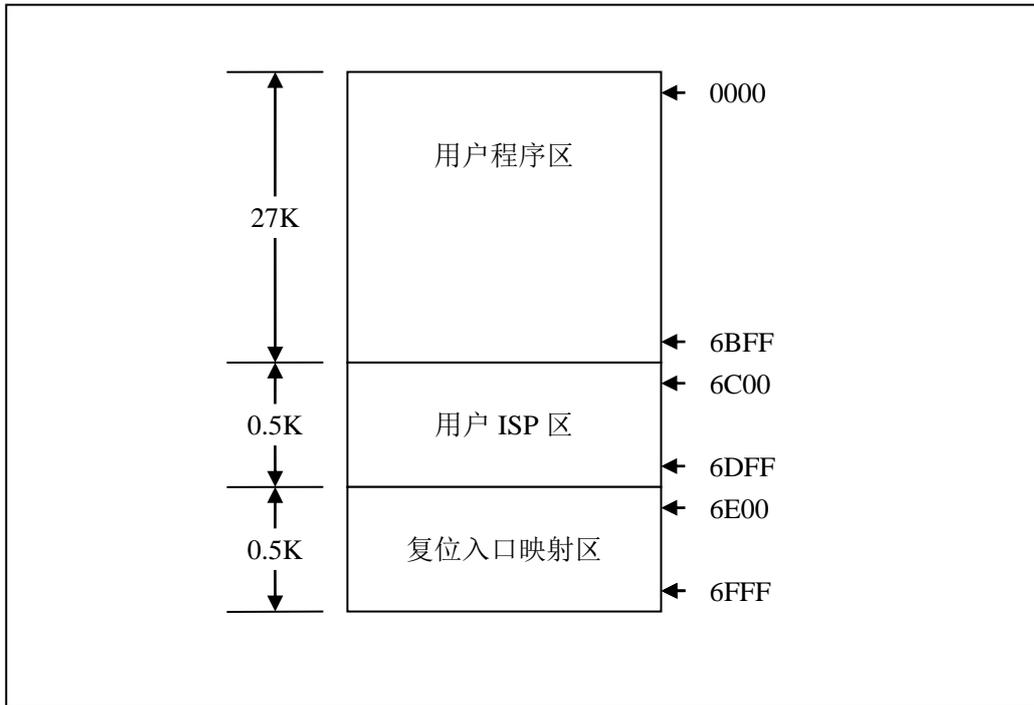
FLASH 空间中, 从地址 0000H 开始的连续 27K 字节的空间为用户程序区。当满足特定的下载条件时, 需要用户将 PC 跳转到用户 ISP 程序区, 此时可对用户程序区进行擦除和改写, 以达到更新用户程序的目的。
