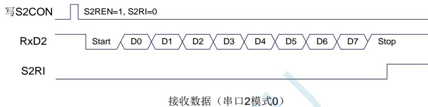
串口 2 的波特率是可变的, 其波特率由定时器 2 产生。当定时器采用 1T 模式时 (12 倍速), 相应的波特率的速度也会相应提高 12 倍。
