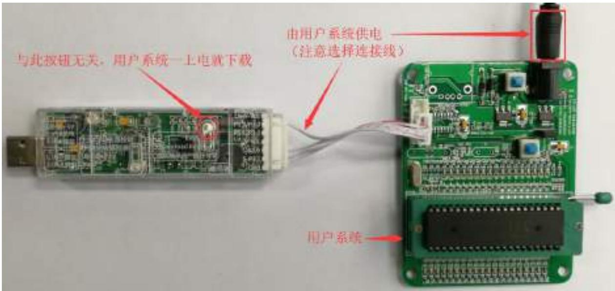
下载的过程中, U8W-Mini 下载工具上的 4 个 LED 会以跑马灯的模式显示。下载完成后, 若下载成功, 则 4 个 LED 会同时亮、同时灭; 若下载失败, 则 4 个 LED 全部不亮。
