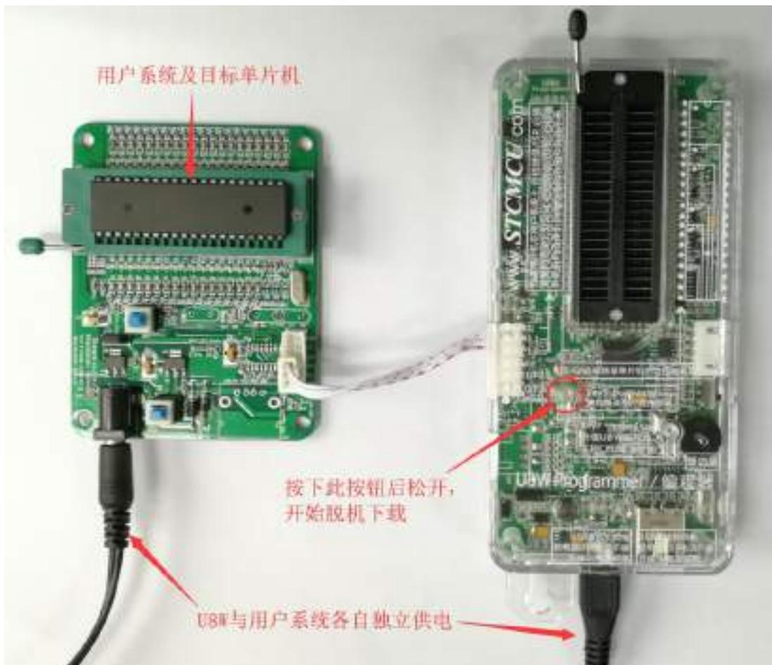
下载的过程中, U8W 下载工具上的 4 个 LED 会以跑马灯的模式显示。下载完成后, 若下载成功, 则 4 个 LED 会同时亮、同时灭; 若下载失败, 则 4 个 LED 全部不亮。
