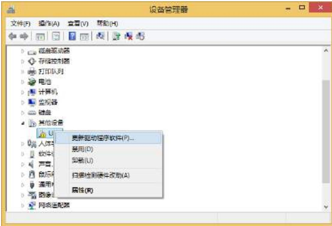
在下面的对话框中选择“浏览计算机以查找驱动程序软件”
