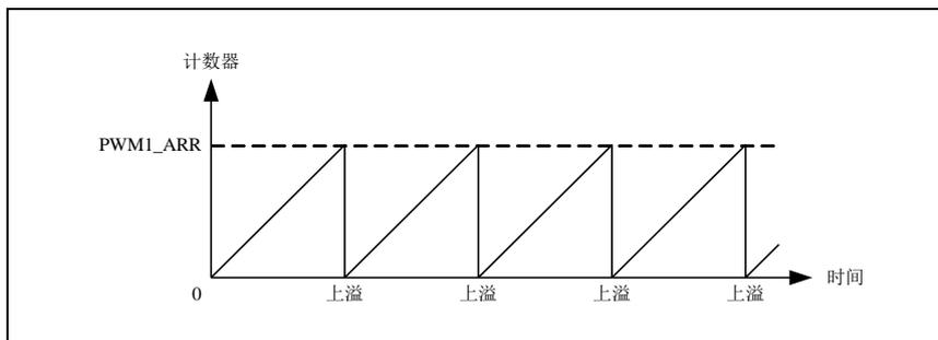
通过软件方式或者通过使用触发控制器置位 PWMA\_EGR 寄存器的 UG 位同样也可以产生一个更新事件。使用软件置位 PWMA\_CR1 寄存器的 UDIS 位，可以禁止更新事件，这样可以避免在更新预装载寄存器时更新影子寄存器。在 UDIS 位被清除之前，将不产生更新事件。但是在应该产生更新事件时，计数器仍会被清 0，同时预分频器的计数也被清 0 (但预分频器的数值不变)。此外，如果设置了 PWMA\_CR1 寄存器中的 URS 位 (选择更新请求)，设置 UG 位将产生一个更新事件 UEV，但硬件不设置 UIF 标志 (即不产生中断请求)。这是为了避免在捕获模式下清除计数器时，同时产生更新和捕获中断。
