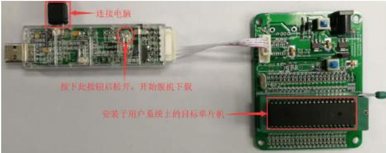
下载的过程中, U8W-Mini 下载工具上的 4 个 LED 会以跑马灯的模式显示。下载完成后, 若下载成功, 则 4 个 LED 会同时亮、同时灭; 若下载失败, 则 4 个 LED 全部不亮。
