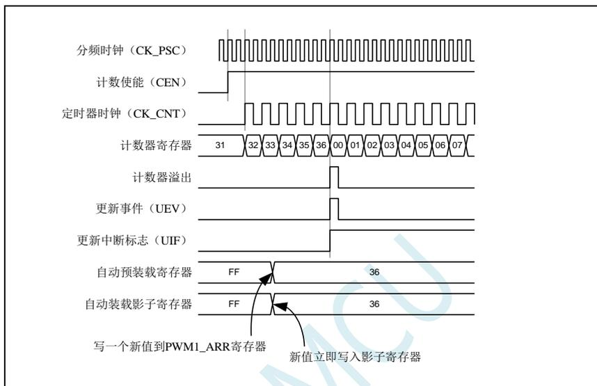
下图的预分频为 1, 因此 CK\_CNT 的频率与 CK\_PSC 一致。图中使能了自动重载 (ARPE=1), 所以在计数器达到 0xFF 产生溢出。0x36 将在溢出时被写入, 同时产生一个更新事件。
