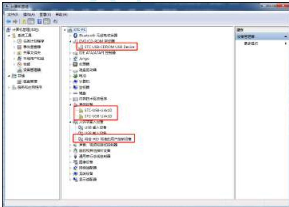
在 Windows 的资源管理器中，打开自动识别的 USB 光驱，里面有就有虚拟串口的驱动。
