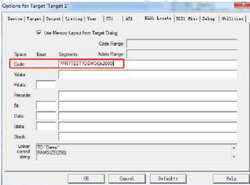
设置完成后，再次编译，函数即可被链接到指定的绝对地址，如下图：
