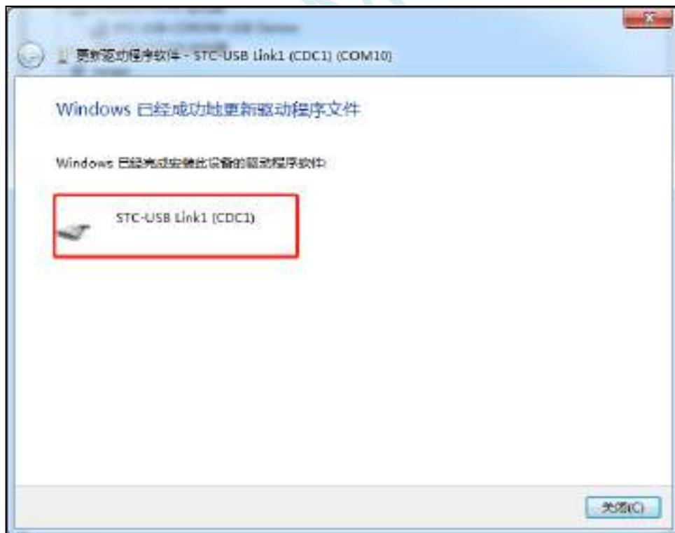
10、第二个 CDC 虚拟串口驱动的安装方法与第一个类似。当两个虚拟串口的驱动都安装完成后，在设备管理器和 STC-ISP 软件中均可找到已安装好驱动的 STC-USB LInk1D 虚拟串口。(STC-ISP 下载软件中可能需要点击“扫描串口”按钮重新扫描才能发现串口)
