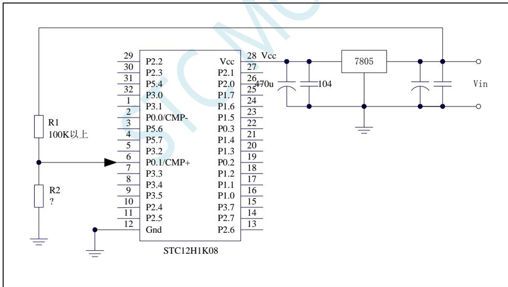
上图中电阻 R1 和 R2 对稳压块 7805 的前端电压进行分压，分压后的电压作为比较器 CMP+ 的外部输入与内部 1.19V 参考信号源进行比较。
