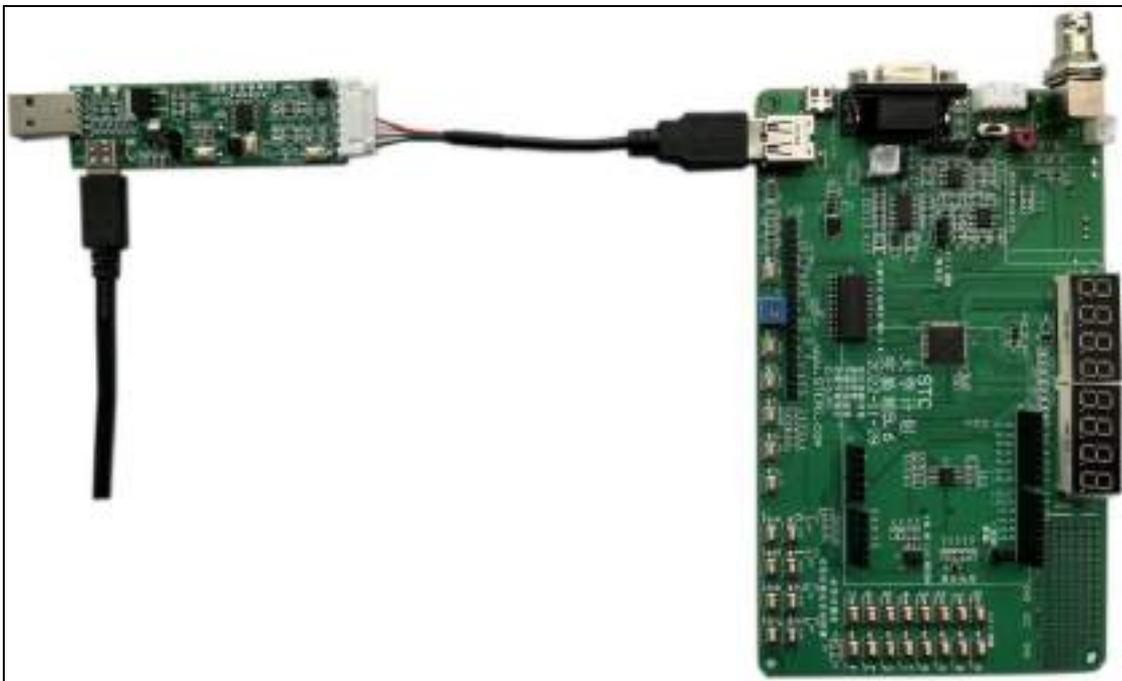
5、一箭双雕用 SIP7-SIP4/2.54mm 普通插座对 STC8 系列 MCU 进行仿真/烧录，硬件连接图如下：
