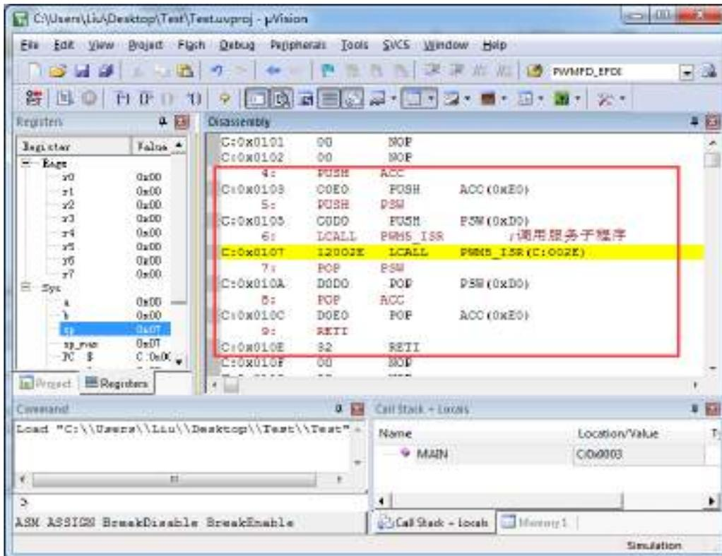
此方法不需要重映射中断入口，不过这种方法有一个问题，在汇编文件中具体需要将哪些寄存器压入堆栈，需要用户查看 C 程序的反汇编代码来确定。一般包括 PSW、ACC、B、DPL、DPH 以及 R0~R7。除 PSW 必须压栈外，其他哪些寄存器在用户子程序中有使用，就必须将哪些寄存器压栈。
