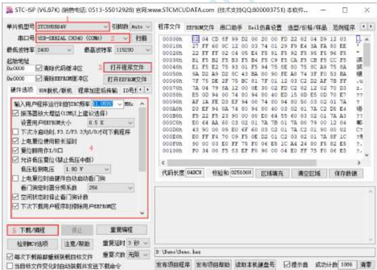
8. 右下角提示框显示“正在检测目标单片机 ...”时按一下 STC 通用 USB 转串口工具上的“电源开关”给 MCU 供电, 即可开始下载【冷启动烧录】;
