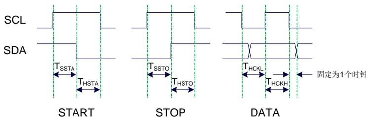
**例 1:** 当 MSSPEED=10 时, T<sub>SSTA</sub>=T<sub>HSTA</sub>=T<sub>SSTO</sub>=T<sub>HSTO</sub>=T<sub>HCKL</sub>=24/FOSC
