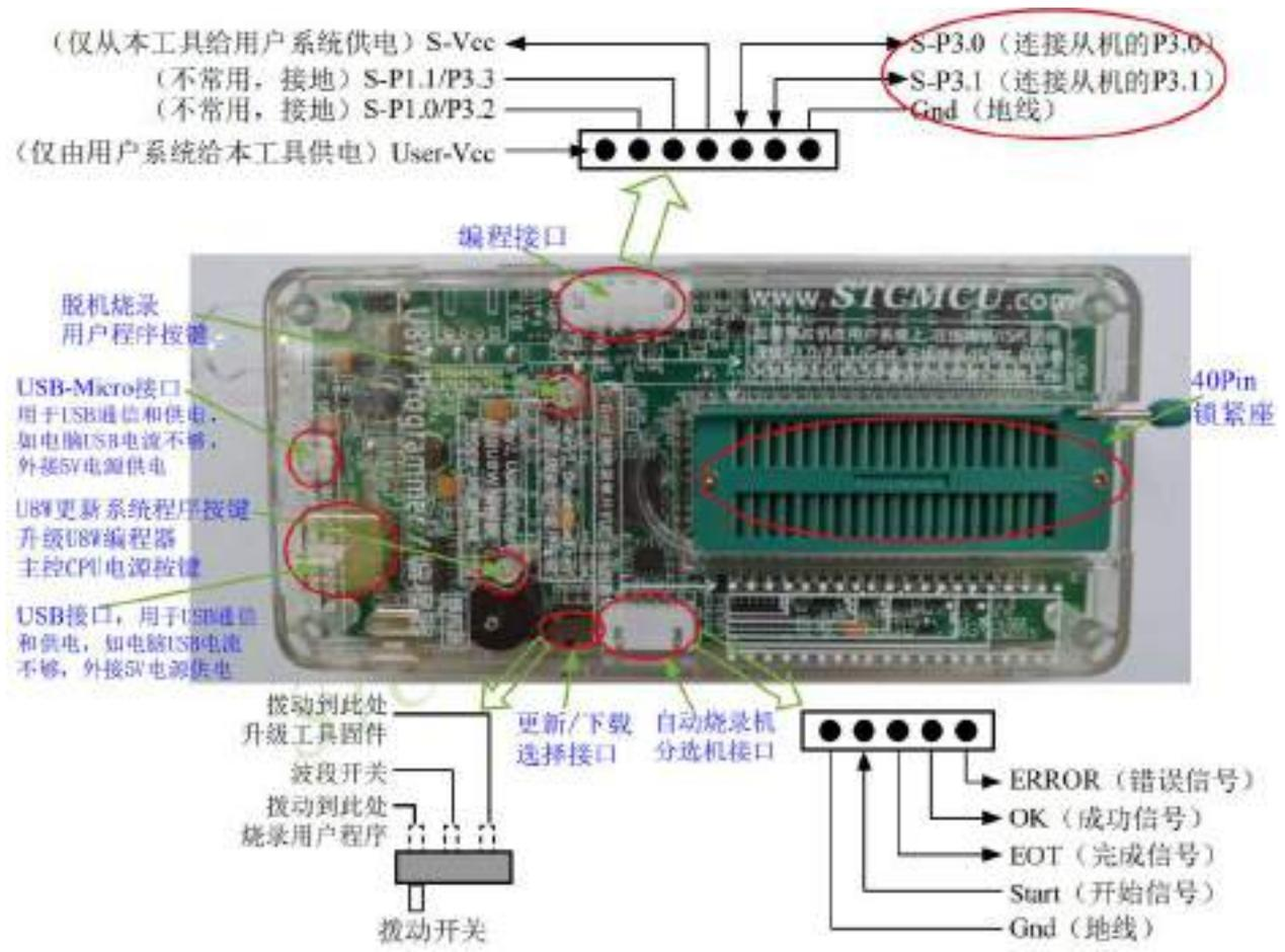
**编程接口:** 根据不同的供电方式, 使用不同的下载连接线连接 U8W 下载板和用户系统。
