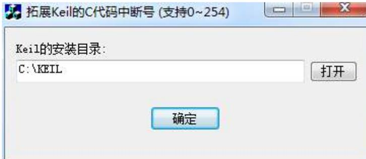
点击“打开”按钮, 定位到 Keil 的安装目录后, 点击“确定”即可。
