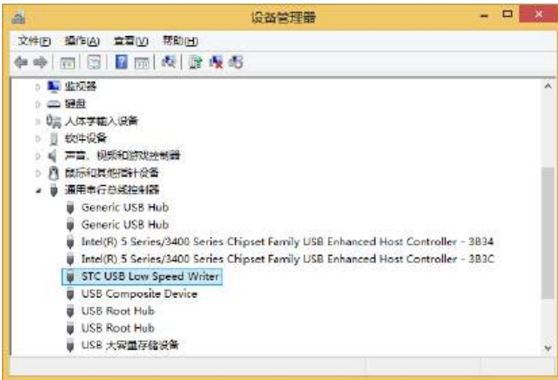
在之前打开的STC-ISP下载软件中的串口号列表会自动选择所插入的USB设备,并显示设备名称为“STC USB Writer (USB1)”, 如下图:
