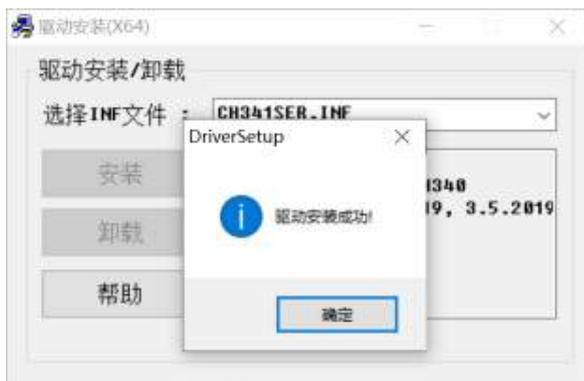
然后使用 STC 提供的 USB 连接线将 U8W/U8W-Mini 下载板连接到电脑，打开电脑的设备管理器，在端口设备类下面，如果有类似“USB-SERIAL CH340 (COMx)”的设备，就表示 U8W/U8W-Mini 可以正常使用了。如下图所示（不同的电脑，串口号可能会不同）：
