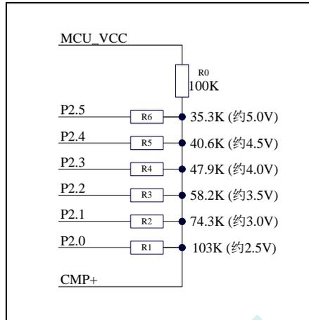
上图中, 利用电阻分压的原理可以近似的测量出 MCU 的工作电压 (选通的通道, MCU 的 IO 口输出低电平, 端口电压值接近 Gnd, 未选通的通道, MCU 的 IO 口输出开漏模式的高, 不影响其他通道)。
