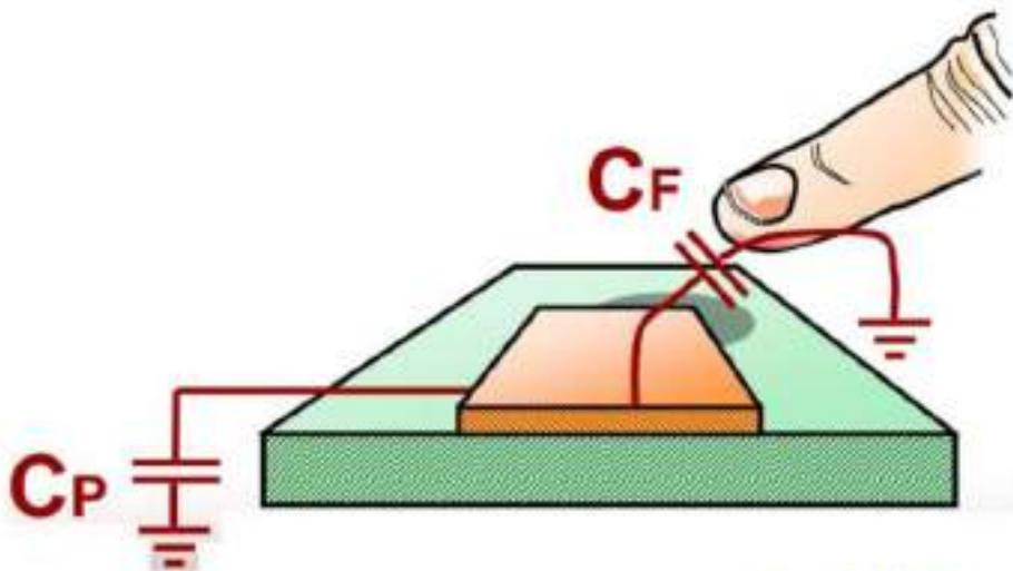
下面为电路图的说明， $C_P$  为金属板和分布电容， $C_F$  为手指电容，并联在一起与  $C_1$  对输入的 300KHZ 方波进行分压，经过  $D_1$  整流， $R_2$ 、 $C_2$  滤波后送 ADC，当手指压上去后，送去 ADC 的电压降低，程序就可以检测出按键动作。
