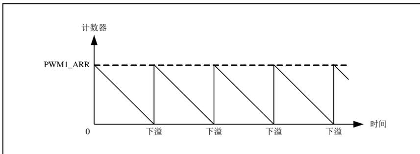
通过软件方式或者通过使用触发控制器置位 PWMA\_EGR 寄存器的 UG 位同样也可以产生一个更新事件。置位 PWMA\_CR1 寄存器的 UDIS 位可以禁止 UEV 事件。这样可以避免在更新预装载寄存器时更新影子寄存器。因此 UDIS 位清除之前不会产生更新事件。然而，计数器仍会从当前自动加载值重新开始计数，并且预分频器的计数器重新从 0 开始（但预分频器不能被修改）。此外，如果设置了 PWMA\_CR1 寄存器中的 URS 位（选择更新请求），设置 UG 位将产生一个更新事件 UEV 但不设置 UIF 标志（因此不产生中断），这是为了避免在发生捕获事件并清除计数器时，同时产生更新和捕获中断。
