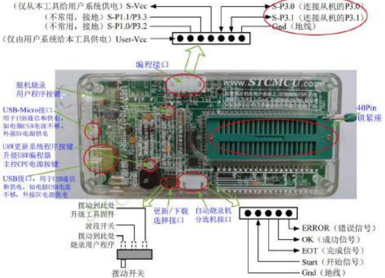
若要使用 U8W 进行仿真，首先必须将 U8W 设置为直通模式。U8W/U8W-Mini 实现 USB 转串口直通模式的方法如下：
