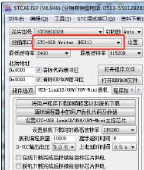
3、点击 STCAI-ISP 下载软件中“USB-Link1D/U8W/U8W-Mini 脱机”页面的“设置 STC-USB Link1D/U8W/U8W-Mini 主控芯片”按钮
