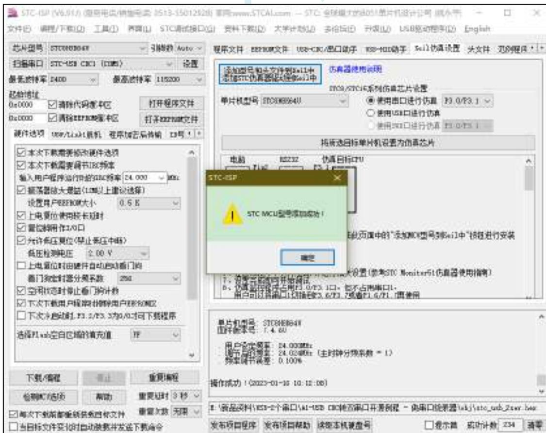
10、现在开始进行 KEIL 仿真的步骤，先将 STC8H8K64U 设置为仿真芯片，STC8H8K64U 目前仅支持串口和 USB 直接仿真。（这里选择了 P3.0/3.1 作为仿真端口，所以程序里不能出现任何占用 3.0 和 3.1 脚的功能，仿真注意事项贴中也会说明，先用点亮一个 LED 的程序进行测试，比较容易观察结果!）此时连接 STC8 的芯片，然后进行如下的设置将开天斧设置成仿真的主控芯片。
