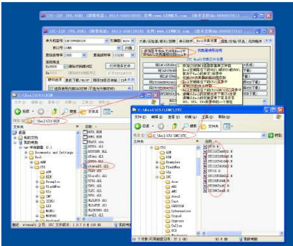
如上图, 首先选择“Keil 仿真设置”页面, 点击“添加 MCU 型号到 Keil 中”, 在出现的如下的目录选择窗口中, 定位到 Keil 的安装目录(一般可能为“C:\Keil\”), “确定”后出现下图中右边所示的提示信息, 表示安装成功。添加头文件的同时也会安装 STC 的 Monitor51 仿真驱动 STCMON51.DLL, 驱动与头文件的安装目录如上图所示。
