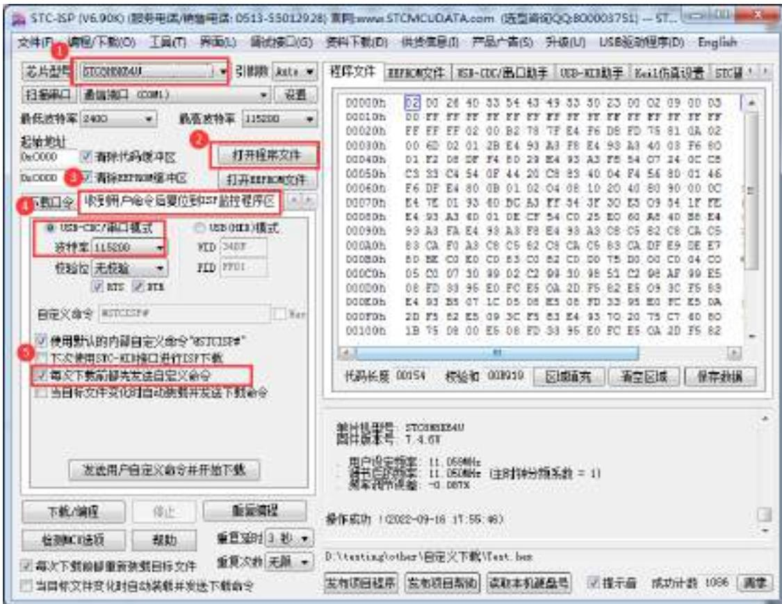
3、第一次下载时需要为目标单片机重新上电，之后的每次更新只需要点击下载软件中的“下载/编程”按钮，下载软件自动将下载命令发送给目标单片机，目标单片机接收到命令后自动复位到系统 ISP 区，即可实现不停电更新用户代码。
