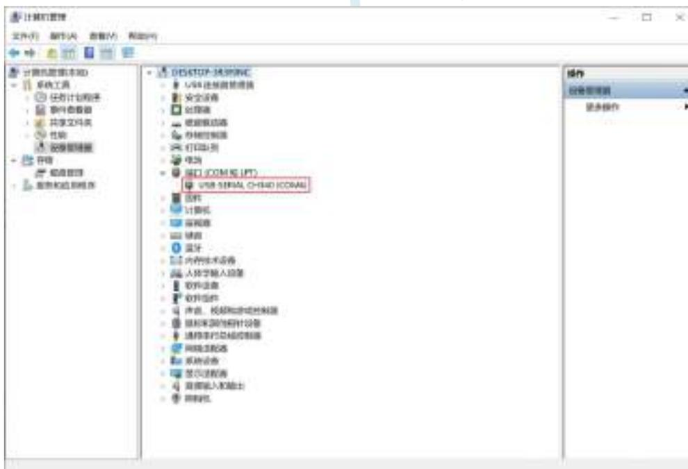
注意：在后面使用 STC-ISP 下载软件时，选择的串口号必须选择与此相对应的串口号，如下图所示：
