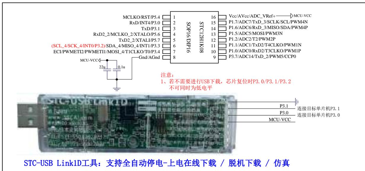
备注: STC12H1K08 系列的 SOP16 的封装形式, P3.2/P3.3 在芯片内部是 2 个独立的 I/O, 但封装时直接短接在一起, 方便大家选择。
