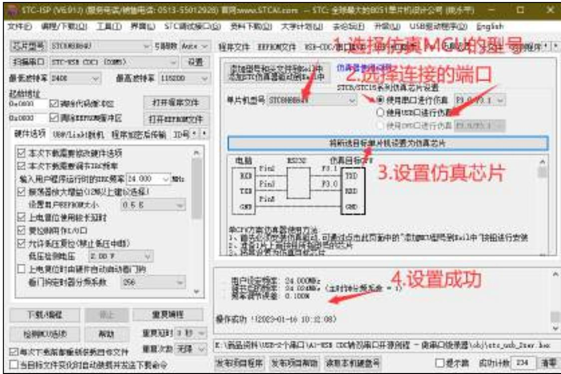
11、开天斧设置为仿真芯片，打开 KEIL 中建好的工程项目，直接去 KEIL 中设置仿真的路径。
