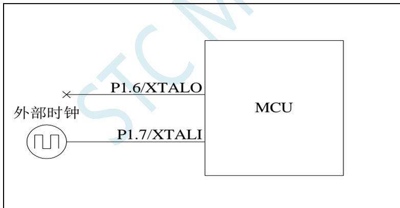
注: 当使用内部时钟时, P1.6/P1.7 都可以当普通 I/O 使用。当 P1.7 口外接有源时钟或外接其他时钟源时, P1.6 口为高阻输入模式, 可当输入口使用, 此时 P1.6 的端口模式不可改变。有 RTC 功能的 MCU, 外部 32768 时钟可从 P1.7 口输入。
