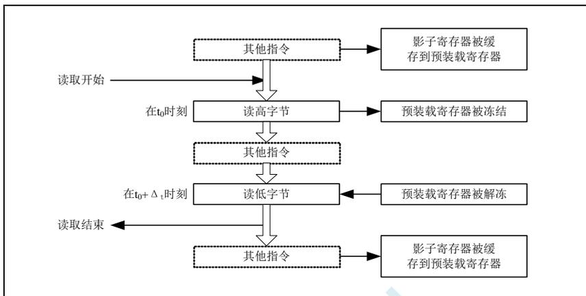
上图描述了 16 位的 CCRi 寄存器的读操作流程，被缓存的数据将保持不变直到读流程结束。在整个读流程结束后，如果仅仅读了 PWMA\_CCRiL 寄存器，返回计数器数值的低位。如果在读了低位数据以后再读高位数据，将不再返回同样的低位数据。
