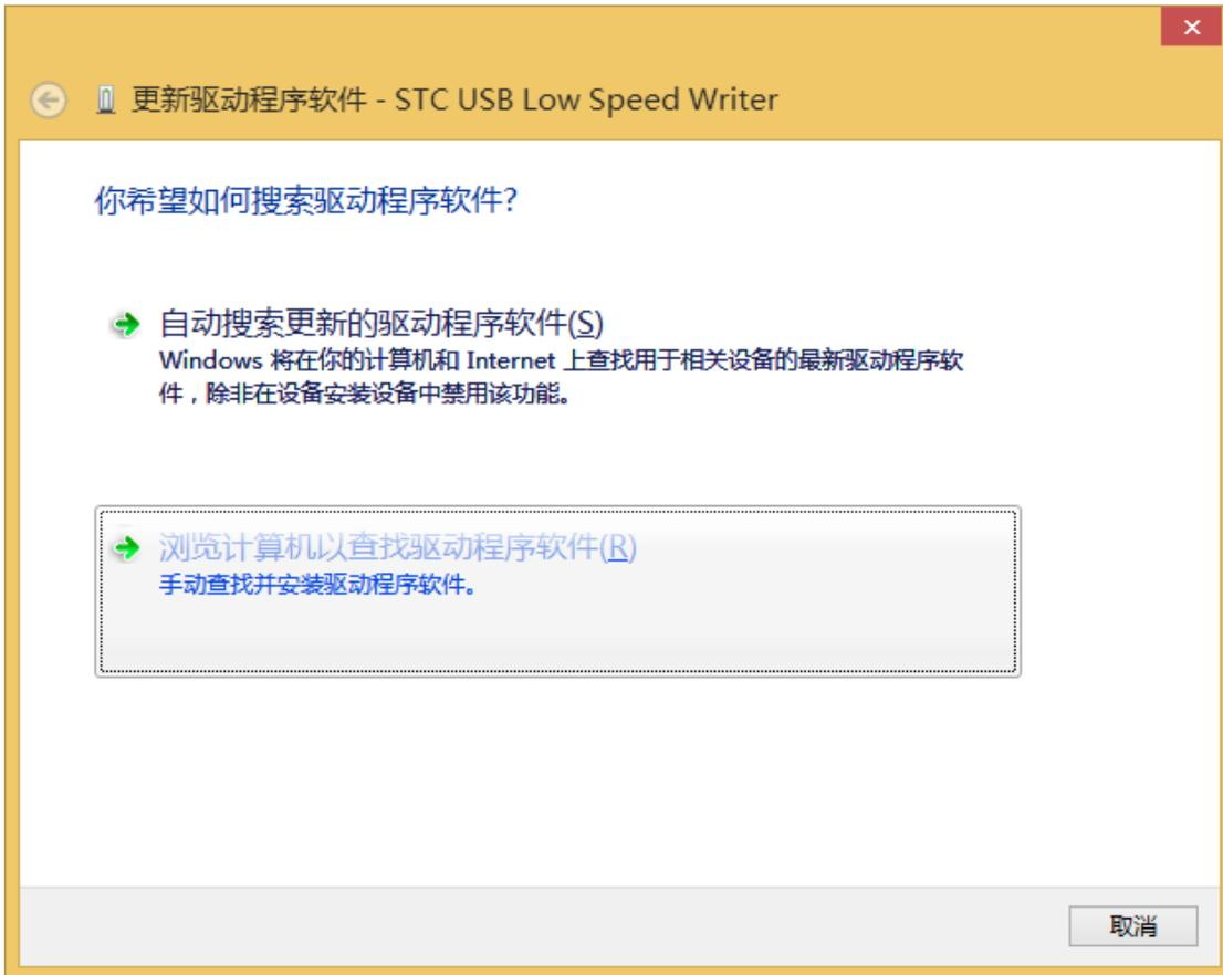
单击下面对话框中的“浏览”按钮，找到之前 STC-USB 驱动程序的存放目录（例如：之前的示例目录为“F:\STC-USB Driver”，用户将路径定位到实际的解压目录）
