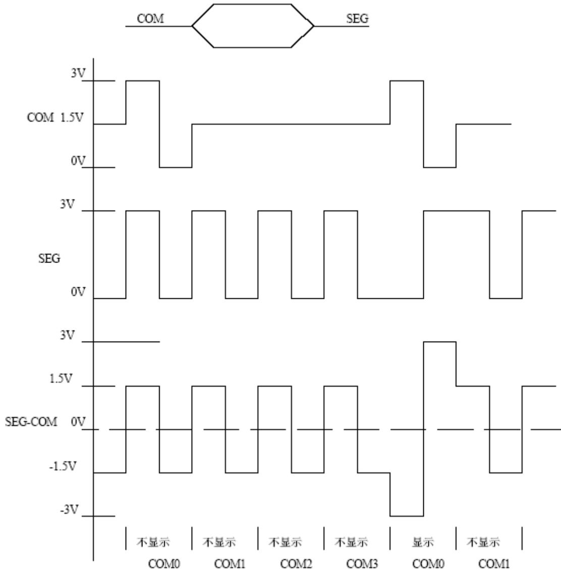
图 4: 驱动 1/4Duty 1/3BIAS 3V LCD 的电路
