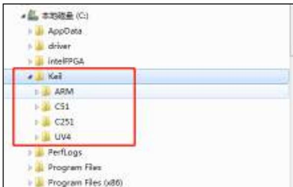
新版本的 Keil 软件的安装目录默认是 C:\Keil\_v5, C51、C251 和 MDK 分别会被安装在 C:\Keil\_v5 目录下的 C51、C251 和 ARM 目录中, 如下图所示。
