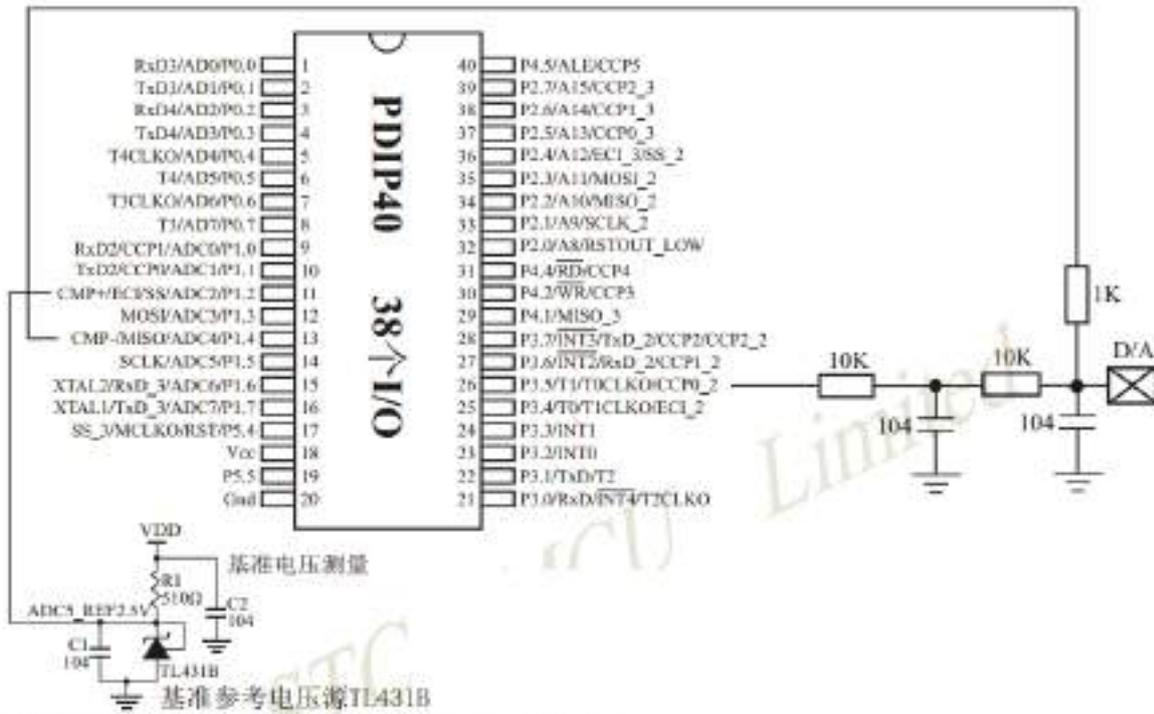
如应用简单, 可无需基准参考电压源, 直接与Vcc比较即可。
