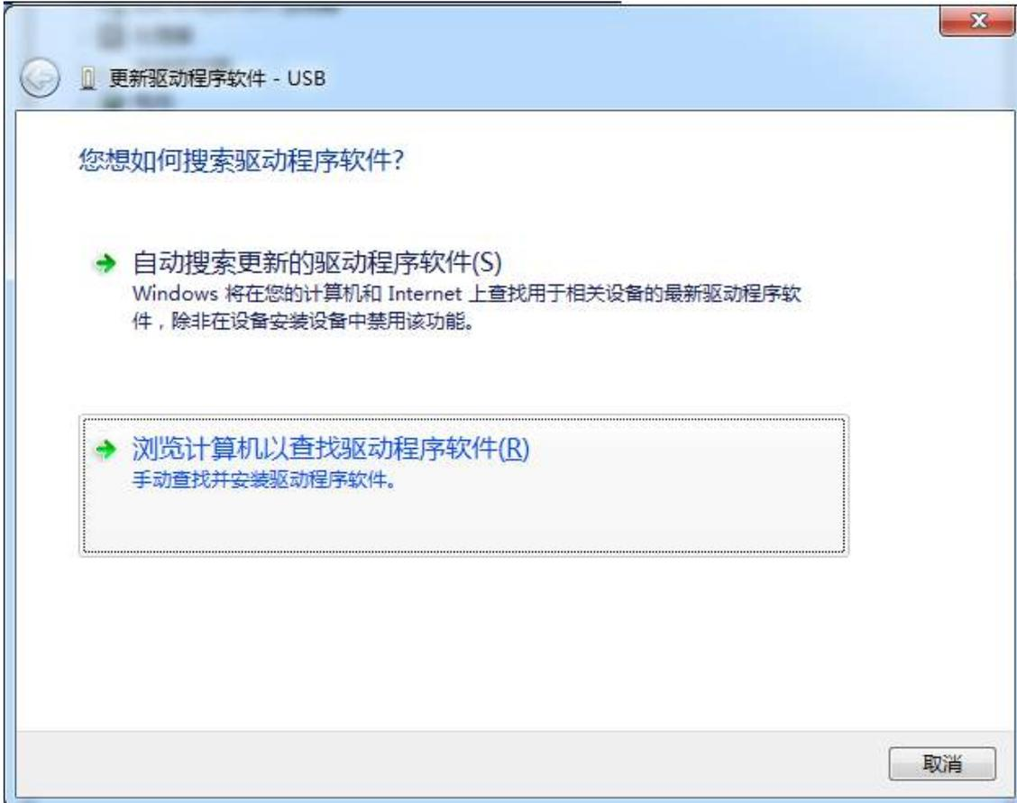
单击下面对话框中的“浏览”按钮，找到之前 STC-USB 驱动程序的存放目录（例如：之前的示例目录为“D:\STC-USB”，用户将路径定位到实际的解压目录）
