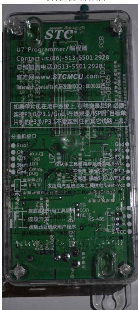
U7安装外壳的反面图
