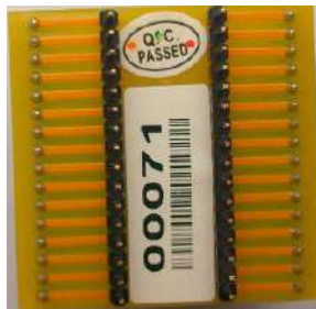
SOP-32的转换座(反面)
