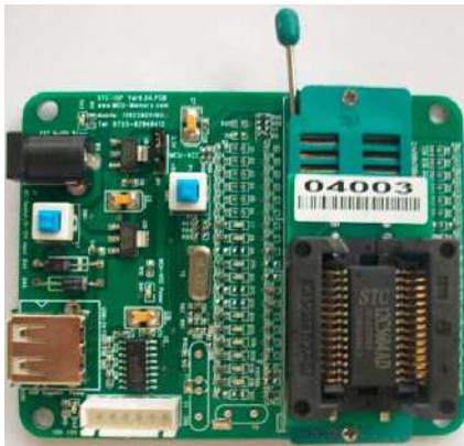
SOP-28转换座的安装
