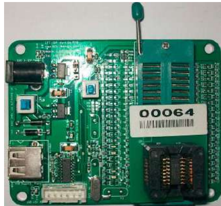
SOP-16转换座的安装
