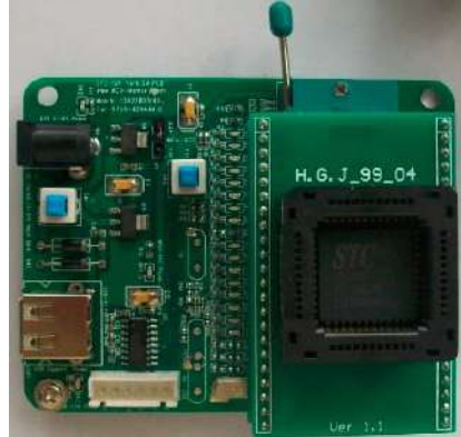
SOP-32转换座的安装
