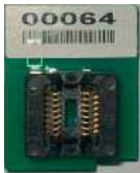
SOP-16和SOP-8的转换座(正面)
