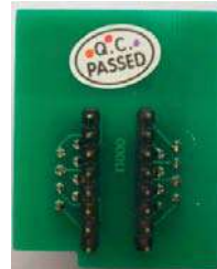
SOP-16和SOP-8的转换座(反面)
