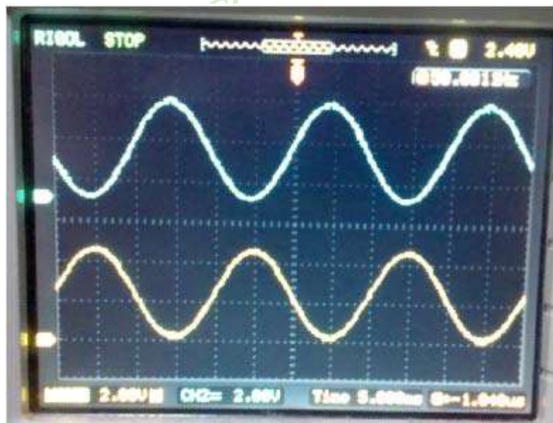
图4: 经过RC滤波后两路反相的正弦波50.001HZ
