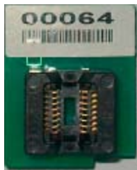
SOP-16和SOP-8的转换座(正面)
