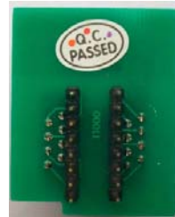
SOP-16和SOP-8的转换座(反面)
