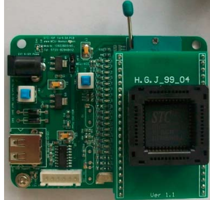
SOP-32转换座的安装
