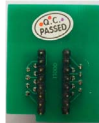
SOP-16和SOP-8的转换座 (反面)
