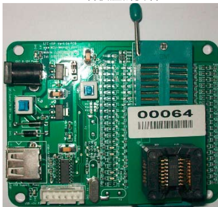
SOP-16转换座的安装
