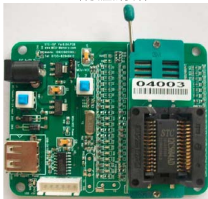
SOP-28转换座的安装
