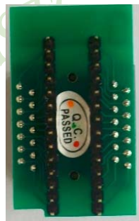
SOP-28和SOP-20的转换座 (反面)
