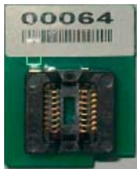
SOP-16和SOP-8的转换座 (正面)
