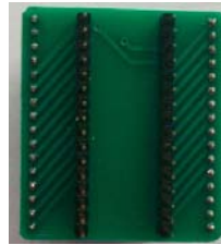
LQFP-32的转换座(反面)
