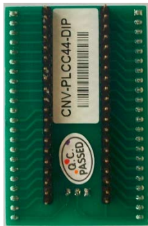
PLCC-44的转换座(反面)
