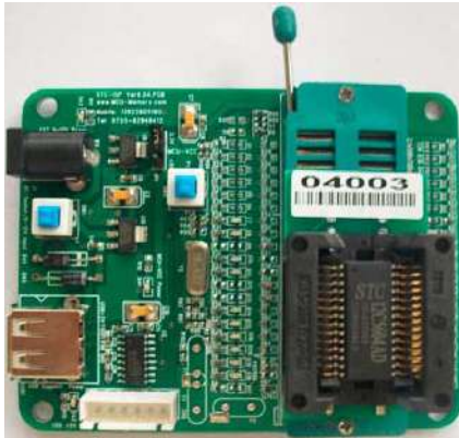
SOP-28转换座的安装
