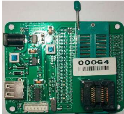
SOP-16转换座的安装
