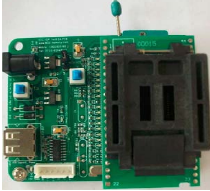
LQFP-32转换座的安装
