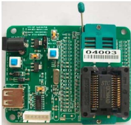
SOP-28转换座的安装
