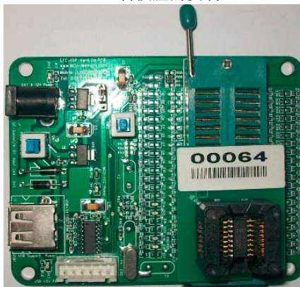
SOP-16转换座的安装
