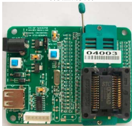
SOP-28转换座的安装
