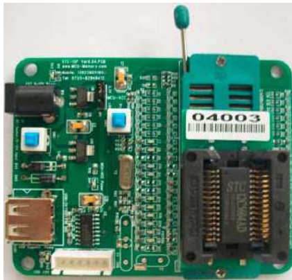
SOP-28转换座的安装
