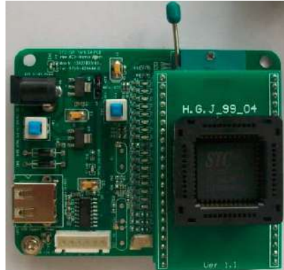
PLCC-44转换座的安装
