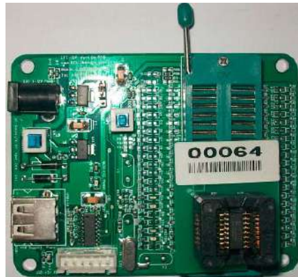
SOP-16转换座的安装
