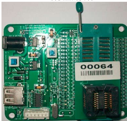
SOP-16转换座的安装
