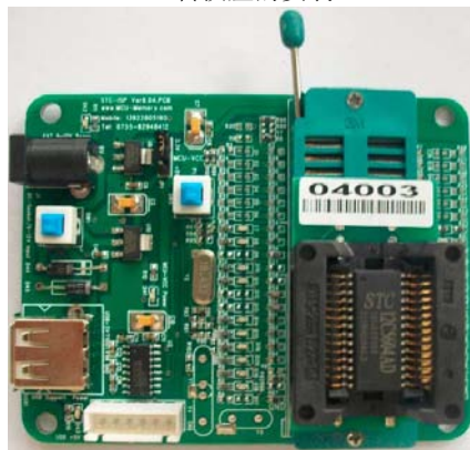
SOP-28转换座的安装
