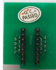
SOP-16和SOP-8的转换座(反面)
