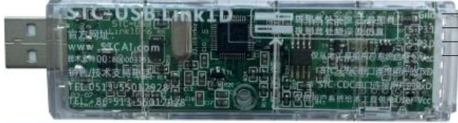
STC-USB Link1D工具: 支持全自动停电-上电在线下载 / 脱机下载 / 仿真
