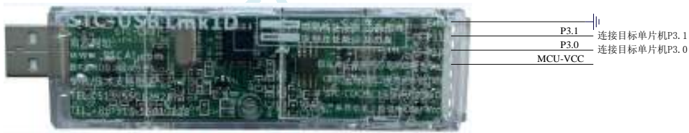
STC-USB Link1D 工具: 支持全自动停电-上电在线下载 / 脱机下载 / 仿真
