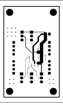
Figure 5. PCB bottom layer
