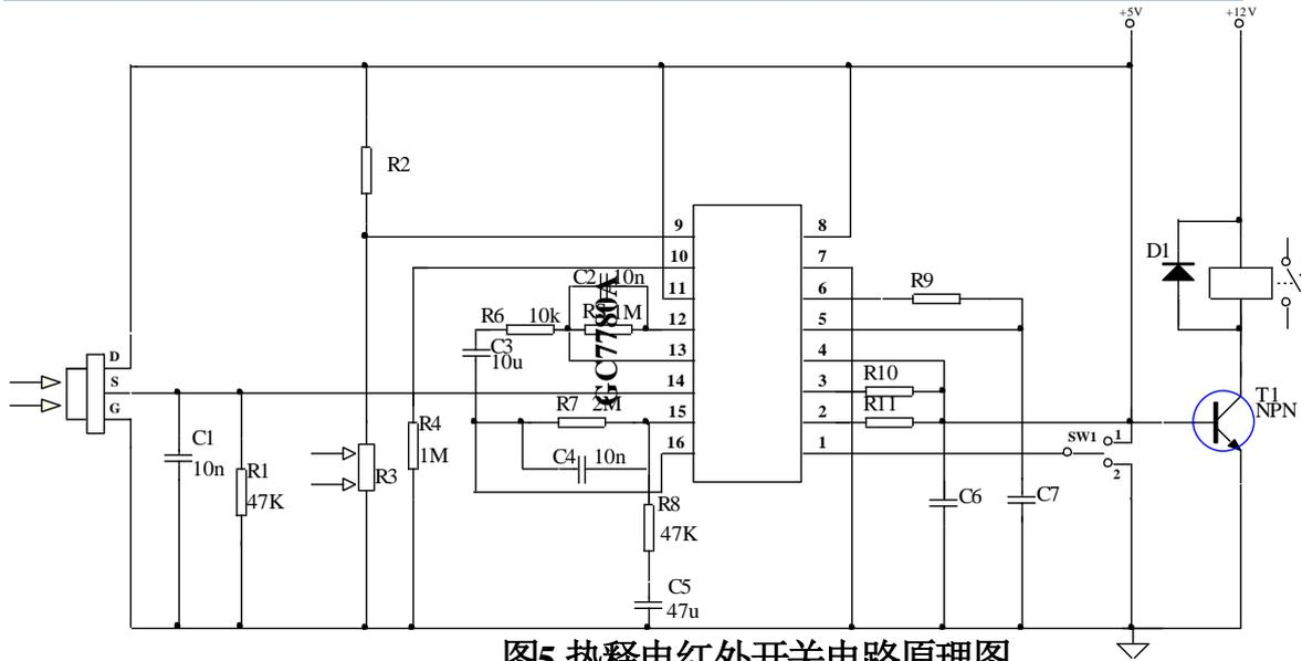
图5 热释电红外开关电路原理图
