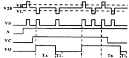
图4 可重复触发工作方式下各点的波形
