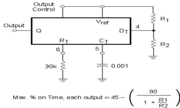
图 16. 软启动电路
