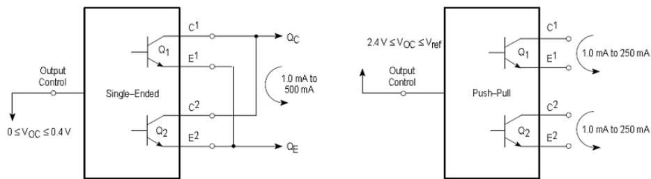
图 18. 驱动两个或者多个控制电路
