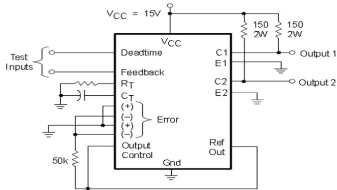
图 12. 共射极电路结构测试电路和波形
