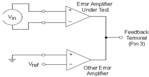
图 11. 死区时间和反馈控制电路
