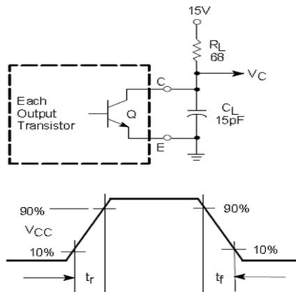
图 13. 射极跟随器结构测试电路和波形
