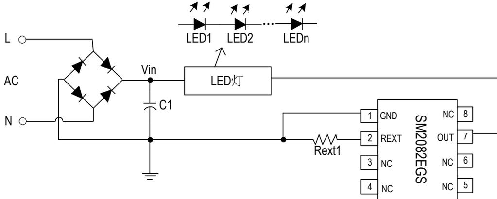
图 5 SM2082EGS 典型应用电路—交流电源输入
