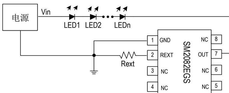
图 4. SM2082EGS 应用电路原理图
