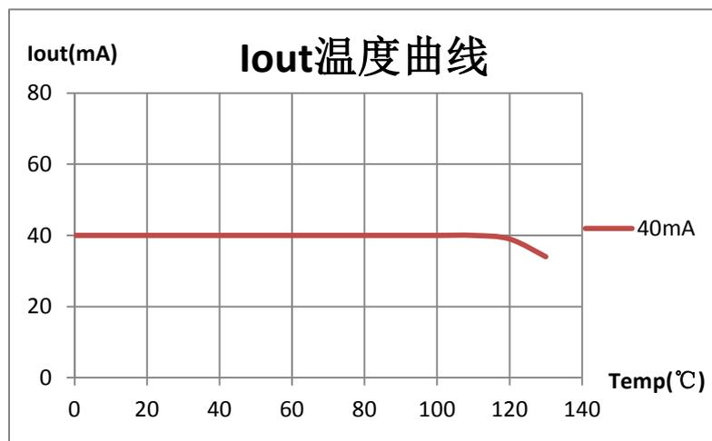
图 3. SM2082EGS 输出电流温度特性（注 7）
