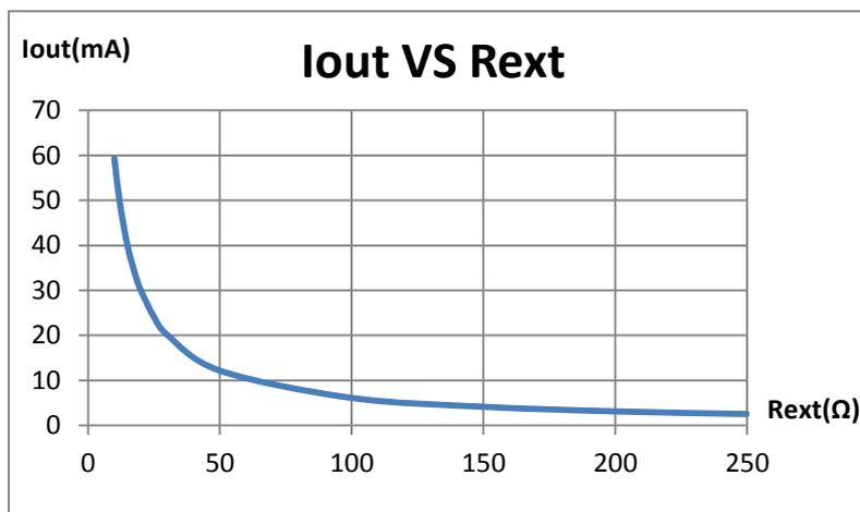
图 1. SM2082EGS 输出电流与 Rext 电阻关系曲线
