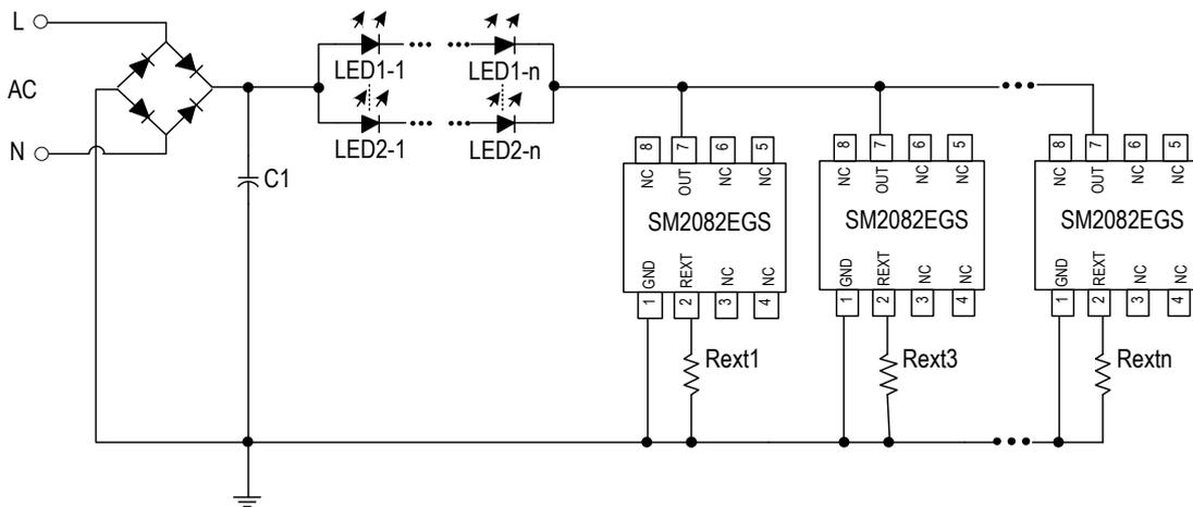
图 6. SM2082EGS 并联应用电路原理图
