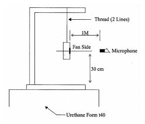
1 METER FROM MICROPHONE TO FAN INTAKE
