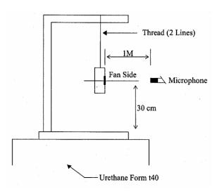
1 METER FROM MICROPHONE TO FAN INTAKE
