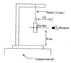
1 METER FROM MICROPHONE TO FAN INTAKE
