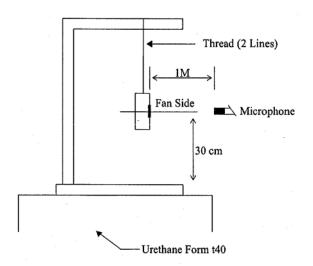
1 METER FROM MICROPHONE TO FAN INTAKE
