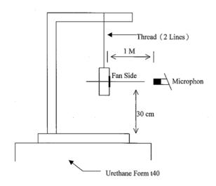
1 METER FROM MICROPHONE TO FAN INTAKE
