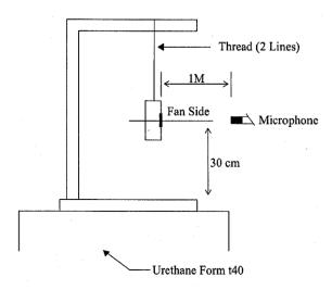
1 METER FROM MICROPHONE TO FAN INTAKE
