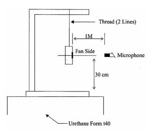
1 METER FROM MICROPHONE TO FAN INTAKE
