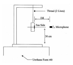
1 METER FROM MICROPHONE TO FAN INTAKE
